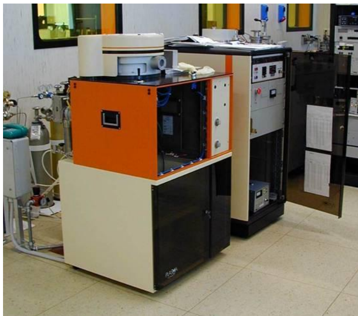
Fig. 36: Impianto utilizzato presso l'IFN per gli attacchi con ioni reattivi (RIE).
