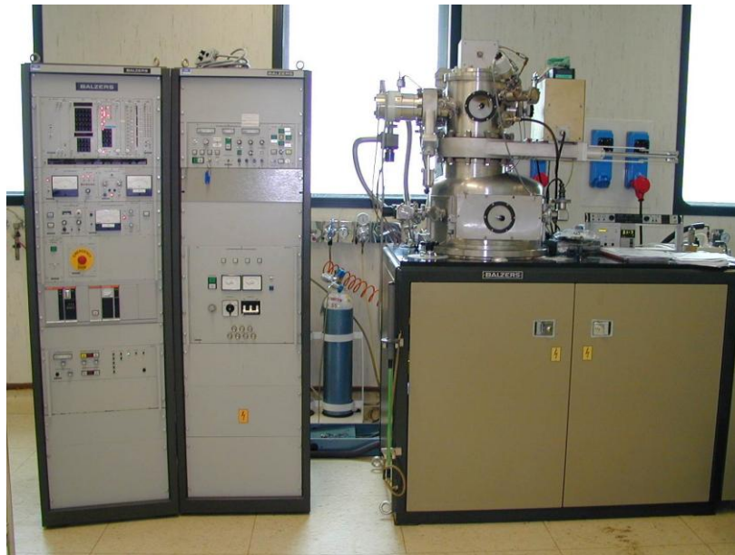
Fig. 29: Impianto di evaporazione a cannone elettronico Balzers utilizzato per la deposizione dei metalli. L'armadio sulla sinistra contiene tutti gli strumenti di controllo dell'evaporatore. Sulla destra è visibile la campana contenente il cannone elettronico e i crogioli e sotto l'armadio con i sistemi da vuoto.
