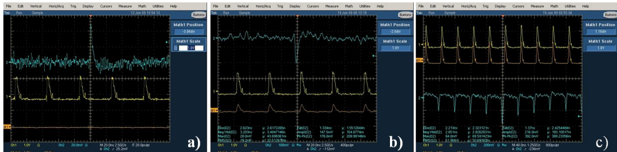
Fig. 83: a) Esempio di non correlazione temporale tra la risposta del SSPD (segnale celeste in alto) e l'impulso pilota (giallo nel mezzo), a causa della quale la media (in rosso in basso) risulta nulla; b) parziale correlazione temporale, la media (in rosso in basso) non riesce a ricostruire correttamente la forma dell'impulso pilota (in giallo in mezzo); c) perfetta sincronia tra i due segnali, la media (in rosso in mezzo) ricostruisce perfettamente la forma dell'impulso pilota (in giallo in alto). Nelle figure b e c l'impulso del SSPD è negativo perché per amplificare il segnale sono stati utilizzati tre amplificatori in serie il cui fattore di amplificazione era negativo, mentre in A sono stati utilizzati solo 2 amplificatori.
