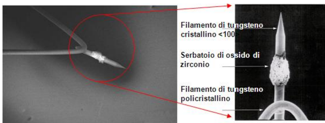
Fig. 26: Immagine SEM della punta dell'emettitore Schottky montato sull'EBPG 5HR;
