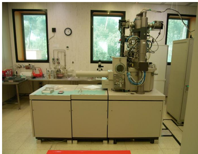
Fig. 24: Fotografia del sistema utilizzato per la litografia elettronica EBPG 5HR della Vistec in uso presso l'IFN.
