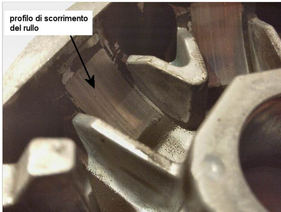
foto 18 – Particolare del profilo di scorrimento del rullo, ricavato all'interno della semipuleggia mobile
