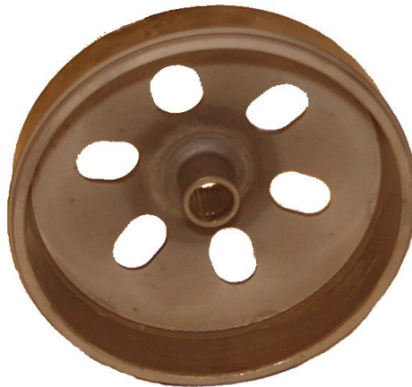
fig. 1.20 – Campana della frizione
