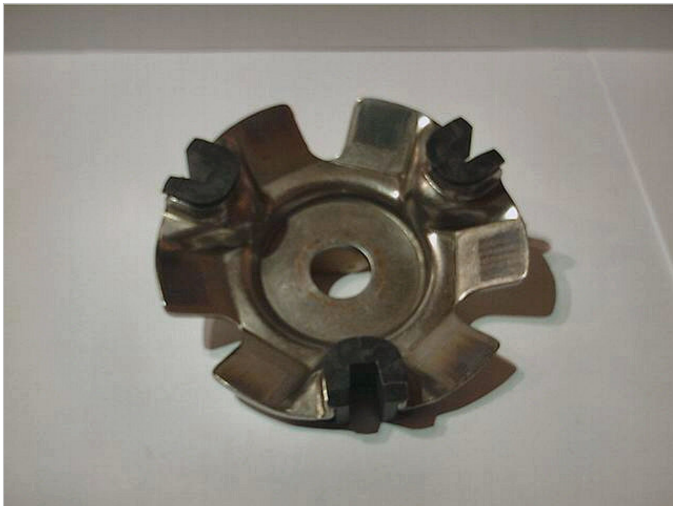
foto 15 – Vista inferiore della piastra fissa assialmente, le zone più lucide sono quelle di contatto con i pesi a rulli
