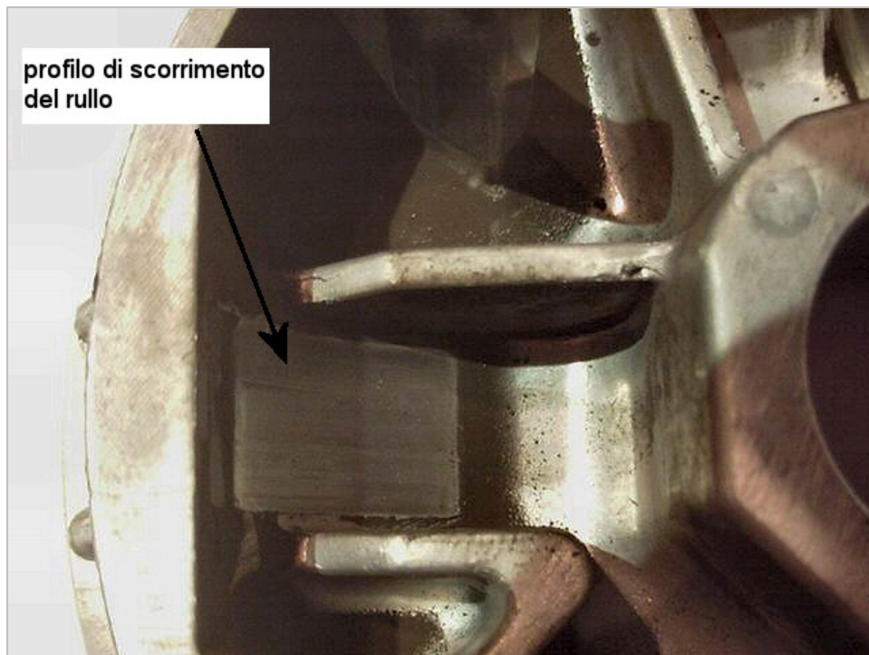
foto 19 – Ingrandimento del profilo di scorrimento del rullo
