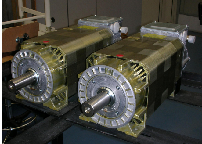
Figura 6.4 Macchine elettriche dell'azionamento del banco prova
