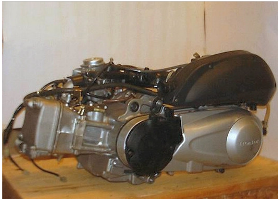
foto 1 – Vista del gruppo motore-forcellone posteriore
