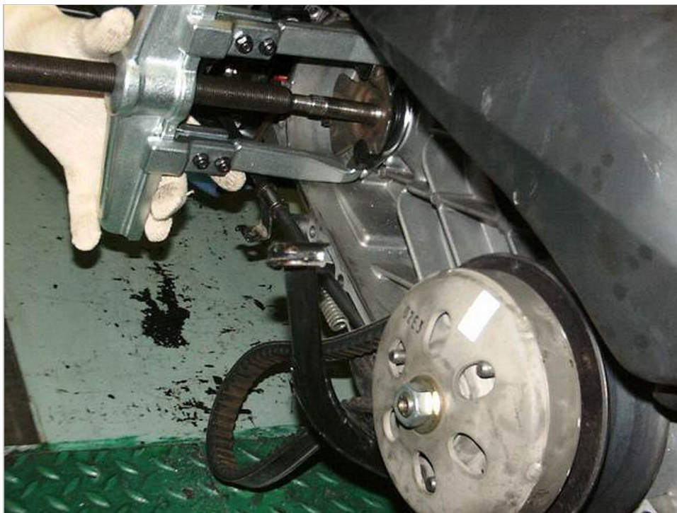
foto 12 – Rimozione della piastra di contrasto della puleggia motrice
