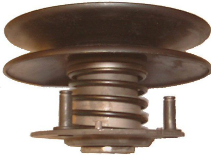
fig. 1.18 – Particolare della puleggia condotta, in evidenza la molla di contrasto e la piastra di trasmissione
