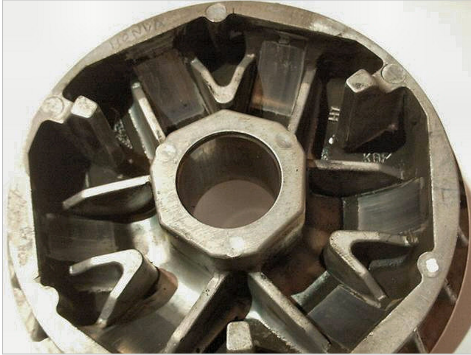
foto 14 – Vista, dopo le prove, dell'interno della semipuleggia mobile motrice, le zone lucidate sono i profili di scorrimento dei rulli
