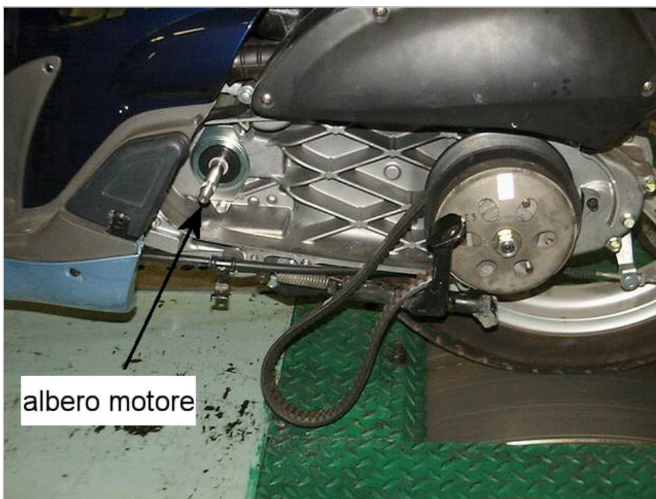
foto 13 – Particolare dell'albero motore su cui è calettata la puleggia motrice
