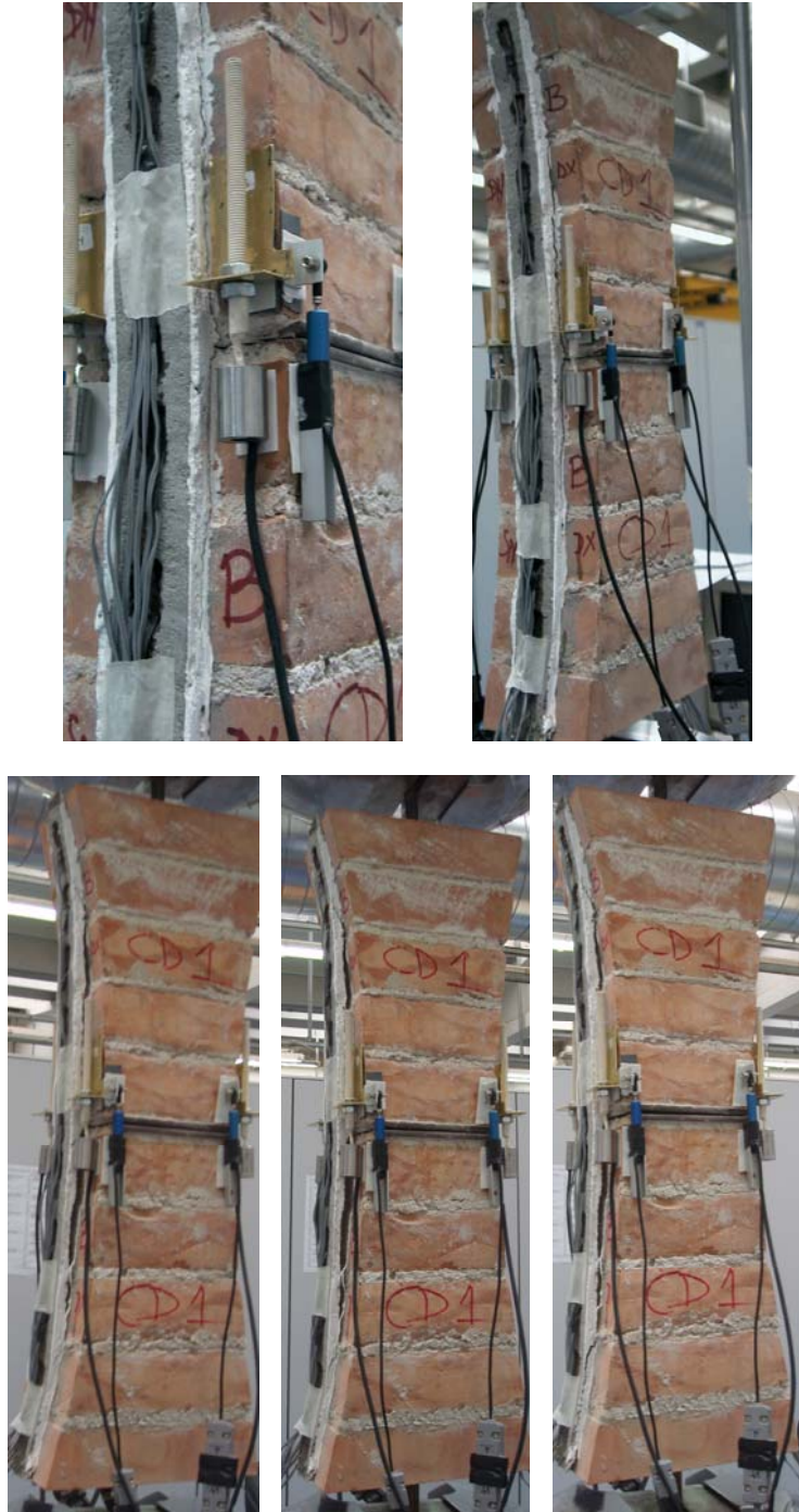
Figura 4.7 delaminazione mista C) D) tra SRG e muratura curva
