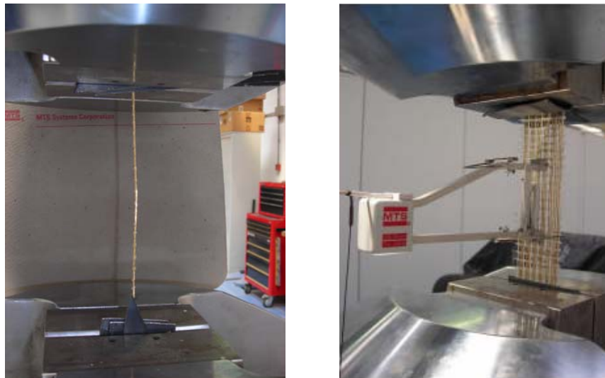
Figura 2.8 prove di trazione su un trefolo (sinistra) e su una striscia di tessuto in acciaio di larghezza 38.1mm (destra)
