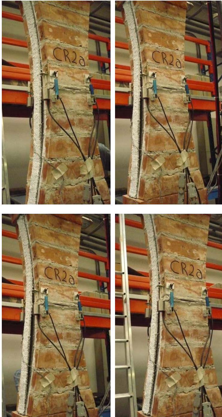
Figura 4.16 delaminazione tra CFRCM e muratura su supporti curvilinei
