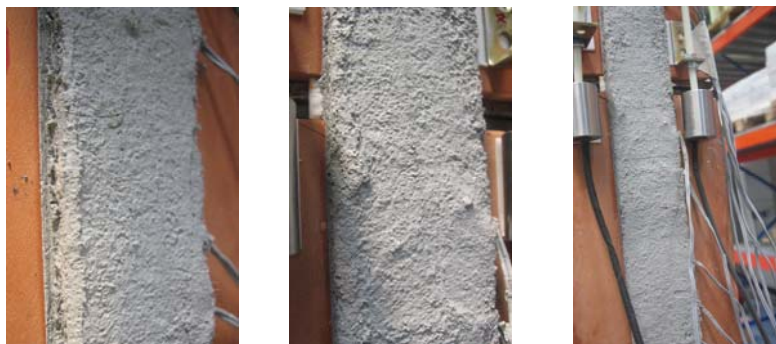
Figura 4.12 dettaglio della fessurazione sulla malta per ancoraggi 220 mm tra CFRCM e mattone
