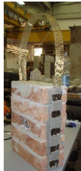
Figura 3.17 campioni tipo F con setup A e lunghezza di ancoraggio 315 mm
