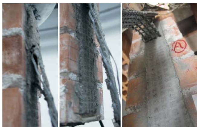
Figura 4.14 dettaglio dell'interfaccia di delaminazione tra CFRCM e muratura
