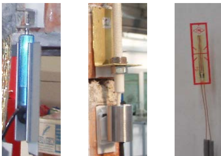
Figura 3.24 traduttore di spostamento potenziometrico (sinistra) e induttivo (centro), strain-gauge 10mm (destra)
