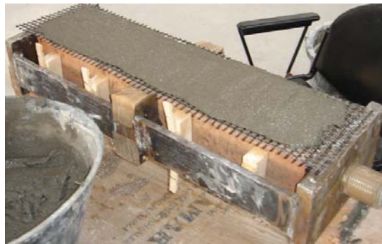
Figura 3.5 prove di pull out di CFRCM su muratura (Faella et al. 2009)
