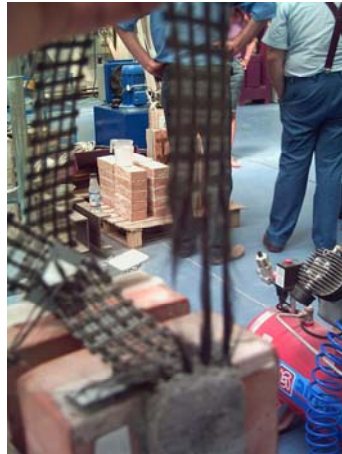
Figura 3.7 prova preliminare con CFRCM in due strati di tessuto su mattone: collasso della fibra.
