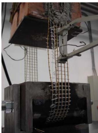
Figura 3.29 prova preliminare con rinforzo 3SX-4 su mattone: collasso della fibra
