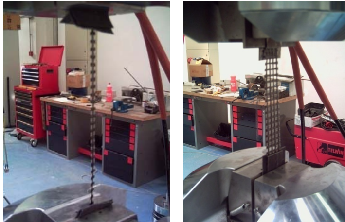
Figura 2.15 prova di trazione sulla singola fascia (sinistra) e su una striscia di 40 mm (destra) di tessuto in carbonio
