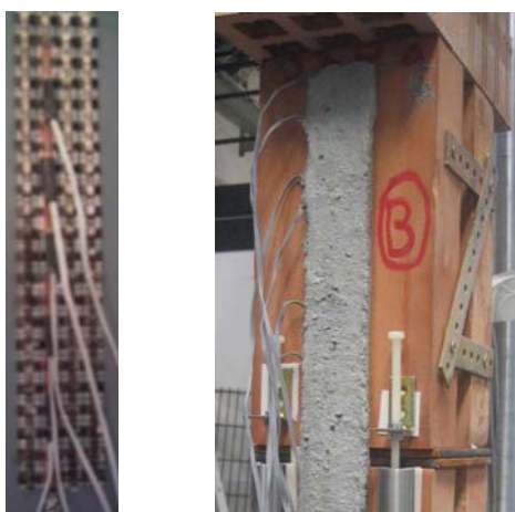
Figura 3.27 dettaglio dell'applicazione degli strain-gauges
