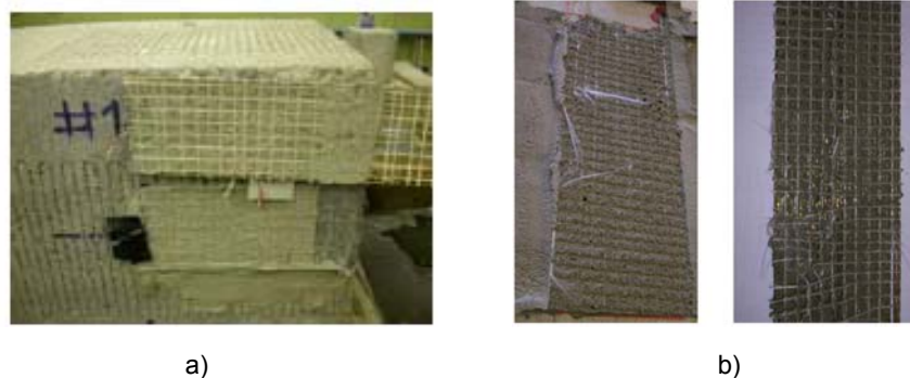
Figura 4.18 delaminazione SRG-calcestruzzo in a) (Matana et al 2005) e b) (Cancelli et al. 2007)
