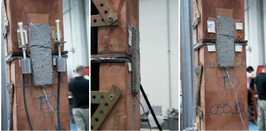
Figura 4.8 delaminazione E) per ancoraggi 55 mm tra CFRCM e mattone
