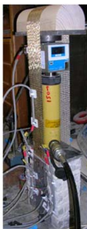
Figura 3.2 prove di pull out di SRG su muratura (Cancelli et al. 2007)
