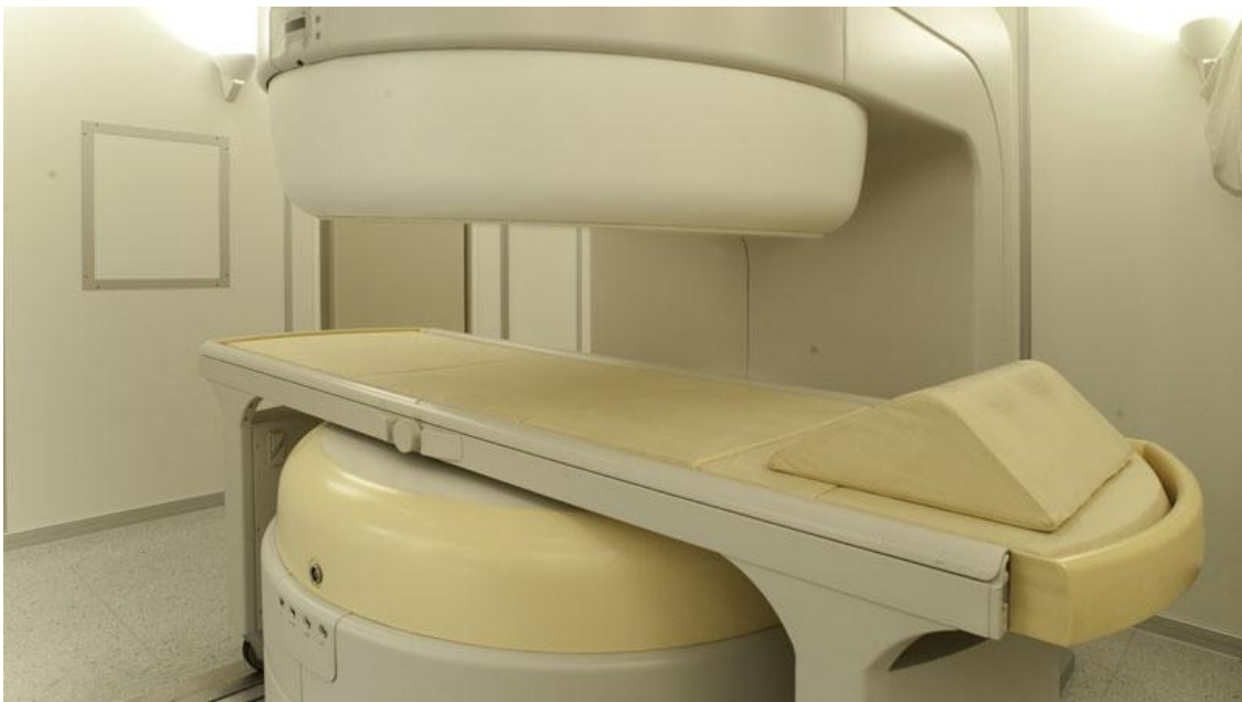
Figura 3.5. Sistema di Risonanza Magnetica aperto. Tale sistema viene detto aperto a causa del magnete permanente che non necessita dell'avvolgimento per intero del paziente all'interno del macchinario, si rende per questo particolarmente adatto per pazienti claustrofobici.
