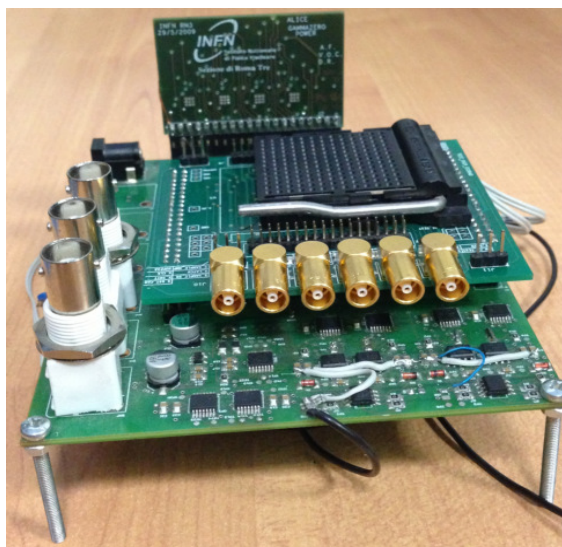
Figura 3.2: Foto delle schede di test, di interfaccia (quella sottostante) e di caratterizzazione (la scheda posta superiormente in cui si può notare lo zoccolo nero per il chip), utilizzate in fase di caratterizzazione del chip.
