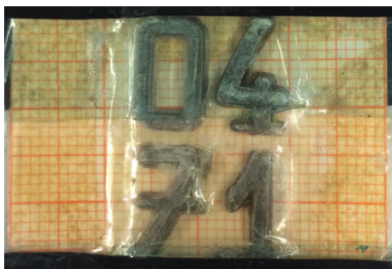
Figura 6.2: Fantoccio di numeri in piombo posizionato davanti al piano di rivelazione della gamma camera descritta in tabella 6.1 (in assenza di collimatore) per ottenere delle immagini in trasmissione con una sorgente di ^{99m}\text{Tc} posta a 3 m davanti al rivelatore, al fine di valutare la bontà delle correzioni proposte.
