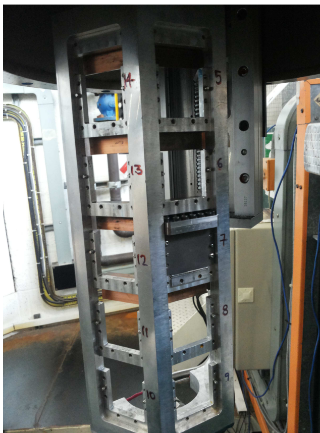
Figura 2.7 – Portacampioni utilizzato su SANDALS. Le celle di Ti-Zr vengono montate negli spazi vuoti numerati: in tal modo è possibile identificare la posizione del campione.
