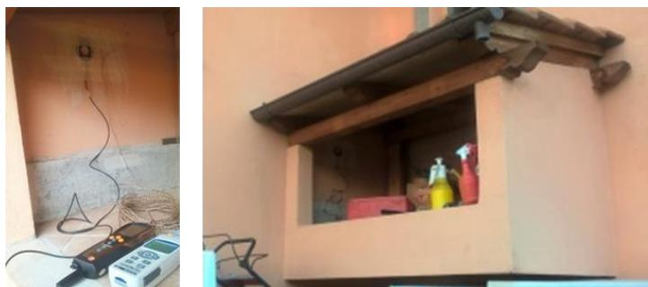
**Figura 61. Applicazione del termoflussimetro e della sonda di temperatura superficiale all'esterno.**
