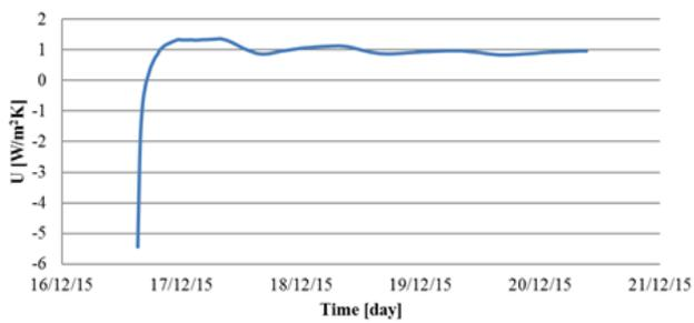
**Figura 63. Trasmittanza termica stabilizzata con il metodo delle medie progressive, misurata dal lato esterno.**
