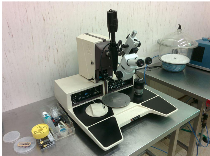
Figura 50: Saldatrice ad ultrasuoni utilizzata per saldare i dispositivi sul relativo chip carrier
