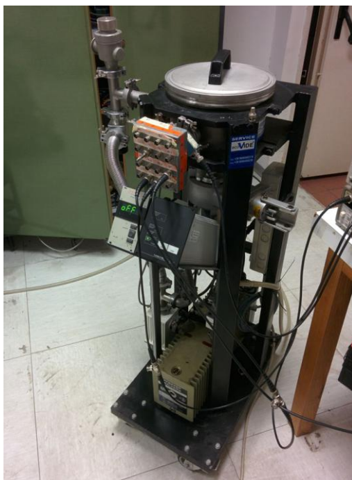
Figura 48: Sistema da vuoto adottato per le misurazioni
