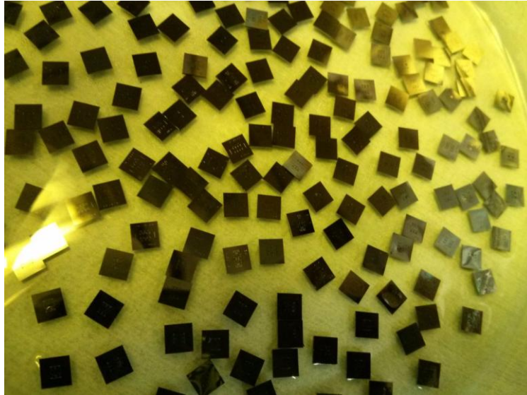
Figura 43: Wafer SOI dopo l'immersione in acetone a valle del taglio con sega in diamante
