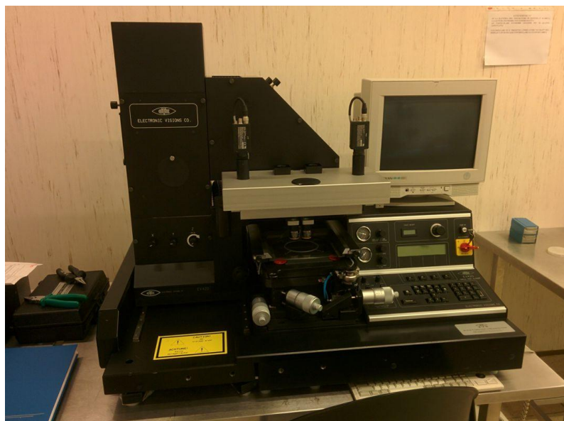
Figura 24: Mask-aligner con possibilità di allineamento fronte-retro
