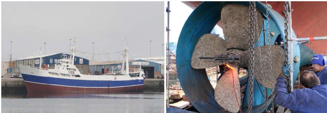
Figura 5.2: Immagini al vero dell'imbarcazione e del propulsore presenti presso il CNR-INSEAN come modelli di carena C2503 (sinistra) ed di elica E1622 (destra).
