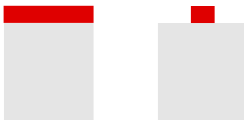
Aggiunte in copertura: a sinistra, aggiunta estesa all'intero piano, a destra, aggiunta puntuale.
