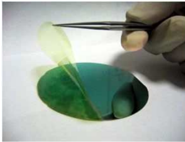
Figura 1.8.1 : Immagine registrata durante la fase di distacco meccanico di un film di polyimide HD2611 da wafer di silicio ossidato termicamente.
