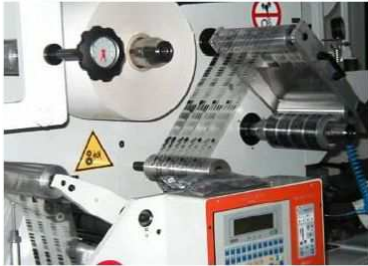
Figura 1.3.1: Schema di un apparato roll-to-roll (R2R).
