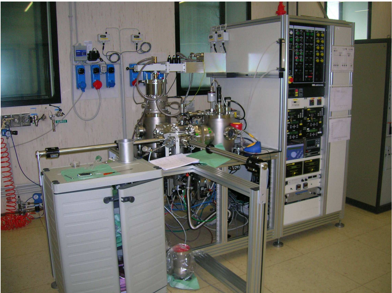
Figura 4.2.2 : Immagine del sistema a due camere, ECR-PECVD e PECVD, utilizzato per la deposizione dei film dielettrici e del silicio amorfo.
