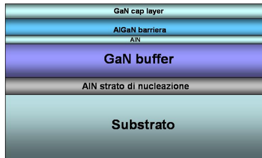
Figura 2.22: schema dell'eterostruttura “avanzata”, avente un sottile strato di AlN tra il GaN e l'AlGaIn
