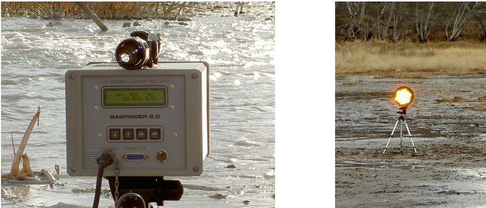
Fig. 2.2 trasmettitore, ricevitore laser e retroriflettore per lunghe distanze
