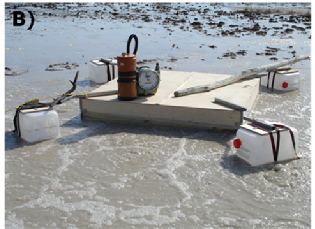
Fig. 2.4 A-Piattaforma galleggiante per il convoglio del gas da forti emissioni dall'acqua, B-contatore volumetrico
