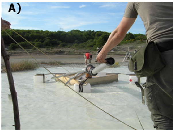
Fig. 2.4 A-Piattaforma galleggiante per il convoglio del gas da forti emissioni dall'acqua, B-contatore volumetrico
