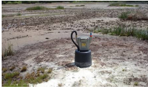
Fig.2.5 Secchio equipaggiato con contatore di gas per misure di flusso viscoso medio-basso dall'acqua.
