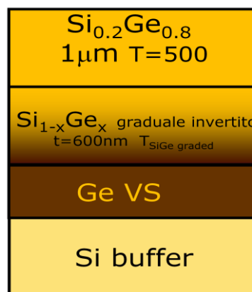
Figura 36: schema dei campioni G_0 ( T_{SiGe} = 500^\circ C ) e H_0 ( T_{SiGe} = 800^\circ C )
