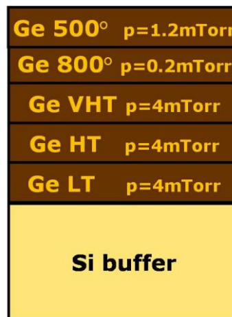
Figura 18: sequenza degli strati di Ge cresciuti nel substrato Ge VS
