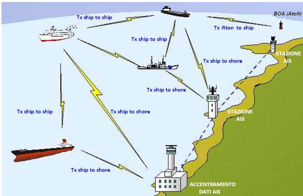
Figura 1.3: uno scenario di scambio dati AIS tra transponder di bordo, base station costiere ed AtoN.
