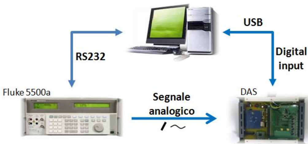
Figura 1.13- Schema di calibrazione della scheda di acquisizione.
