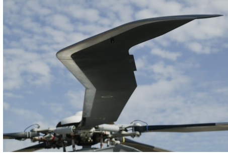
Figura 1.1: Immagine della pala Blue Edge TM in fase di sviluppo da Eurocopter.
