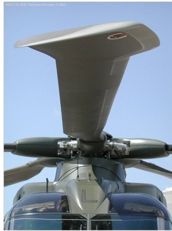
Figura 1.1: Immagine della pala Blue Edge TM in fase di sviluppo da Eurocopter.
