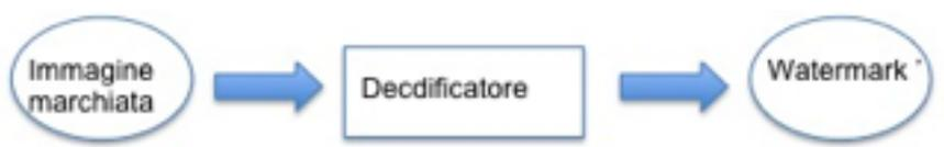
**Figura 2.35.** Schema a blocchi del decodificatore blind
