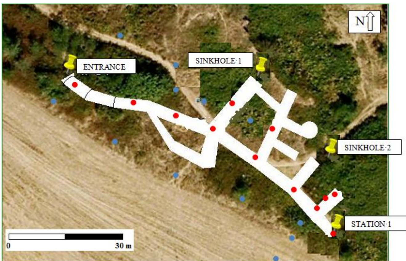
Figura 51: Ubicazione dei punti di misura di soil radon in superficie: ● punti di misura dove non è presente cavità al di sotto; ● punti di misura con presenza di cavità al di sotto.
