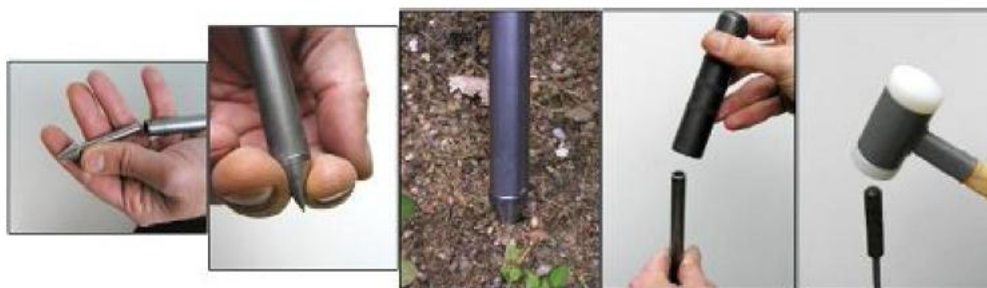
Figura 33: Sonda con punta a perdere, prodotta dalla "RADON v.o.s.".
