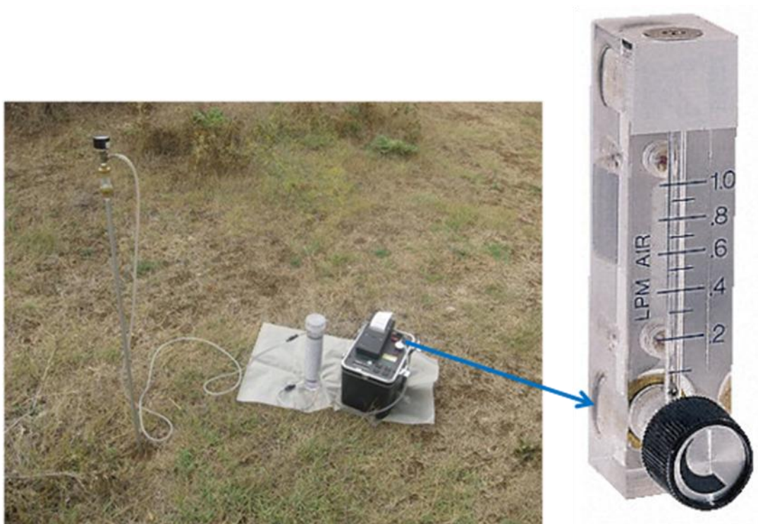
Figura 43: Utilizzo del flussimetro per determinare la portata della pompa RAD7.
