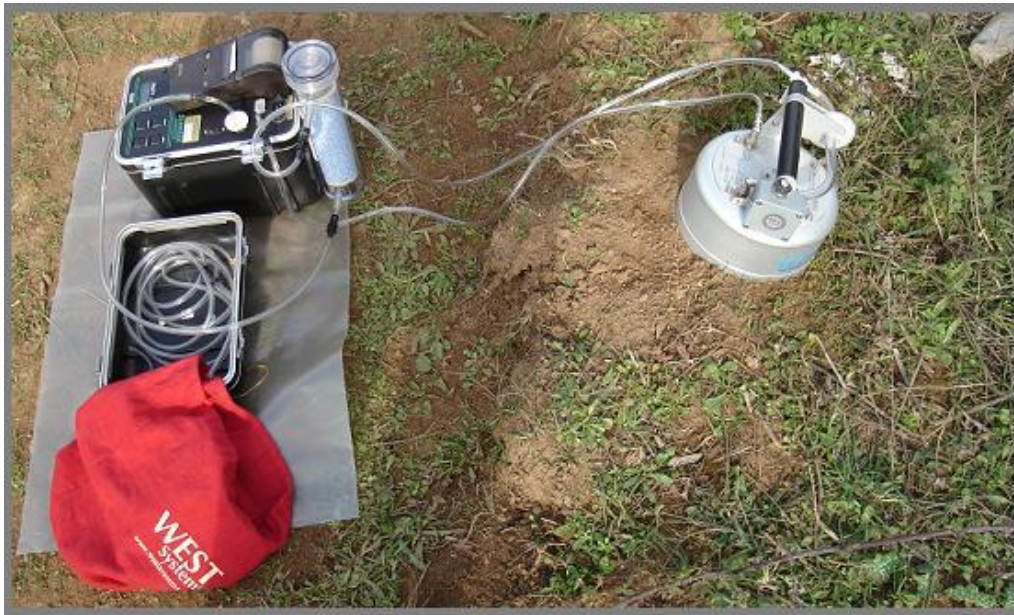
Figura 37: Sistema di misura dei flussi di radon e thoron dal suolo.
