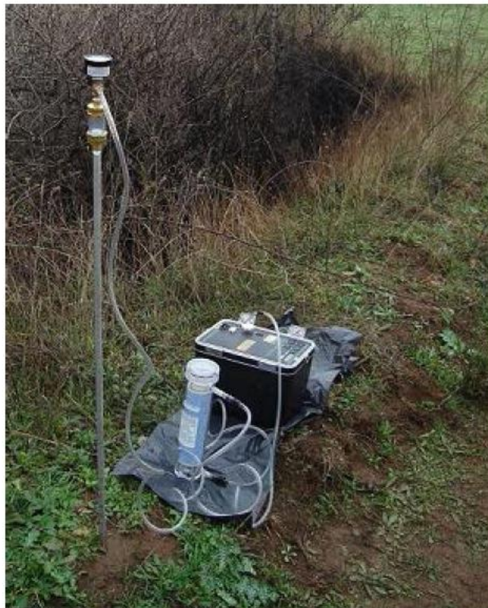
Figura 32: sistema di misura del soil radon.
