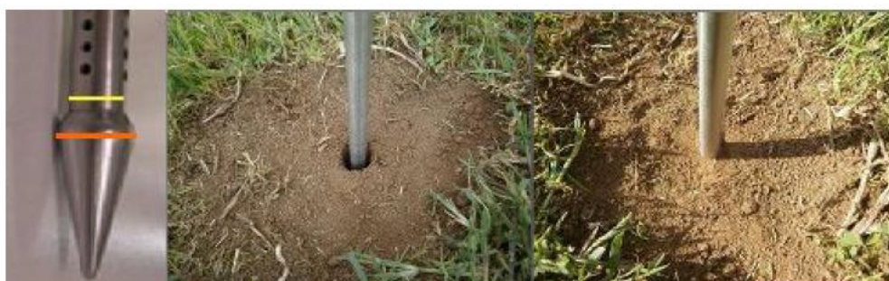
Figura 35: Tipologia di aste con diametro maggiore del resto dell'asta.
