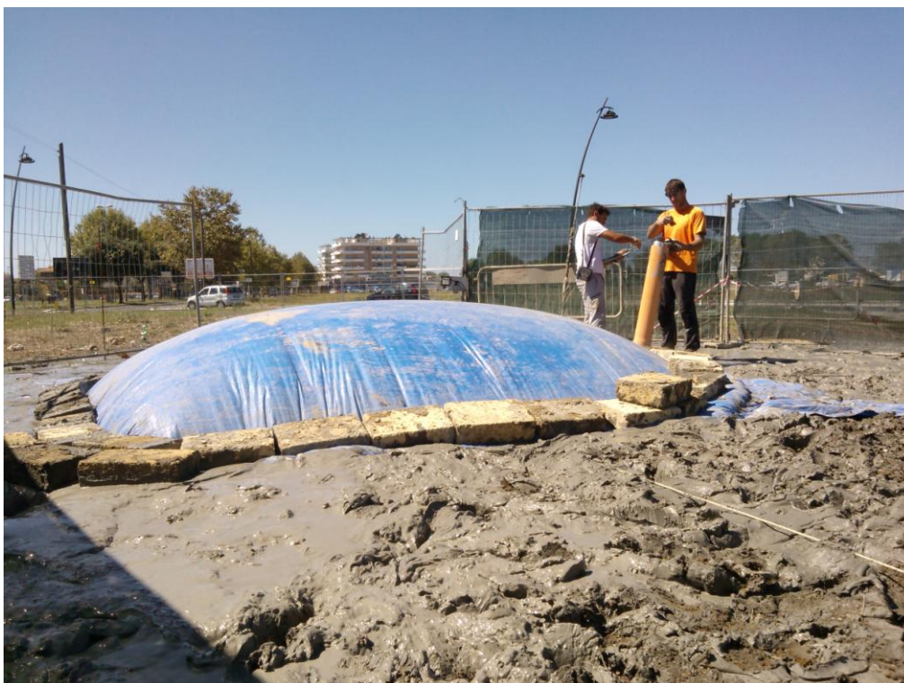
Figura 116: Sistema di misura per la misura del flusso viscoso di CO 2 dalla polla, utilizzato anche per le misure di radon in aria.
