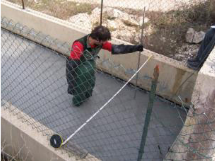
Figura 34 Misura di portata nei canali aziendali dell'area estrattiva
