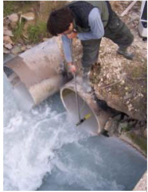
Figura 35 Misura di portata nei canali collettori in cui vengono convogliate le acque delle singole aziende
