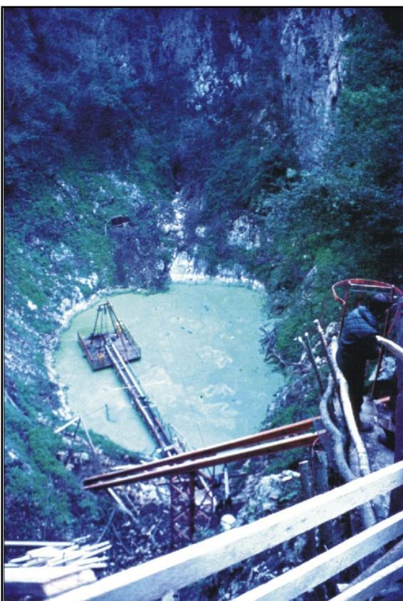
Figura 16 Prove di Pompaggio nel Pozzo del Merro durante gli anni '70 effettuate dall'ACEA.
