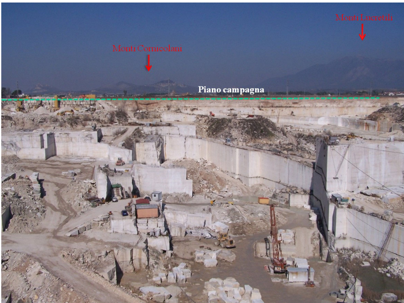
Figura 12 Foto della piana delle acque albule scattata guardando in direzione Nord. Sullo sfondo sono ben visibili i rilievi dei Monti Cornicolani e verso Est i rilievi dei Monti Lucretili. Il taglio della grande cava mette in evidenza l'andamento pianeggiante del piano Campagna e le spesse bancate di travertino leggermente immergenti verso Sud-Est. Subito sotto il piano campagna si nota un limite che mette in evidenza lo strato di qualche metro di travertino "Testina" non litoide, e alcune depressioni colmate di sedimento (paleo sinkholes)
