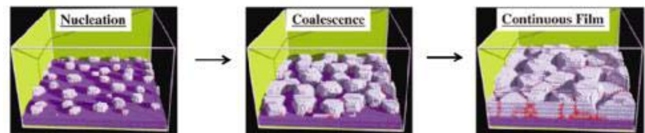
Figura 22: Fasi di nucleazione di un film sottile
