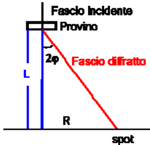
Figura 307: Geometria della diffrazione del fascio nella camera del TEM
