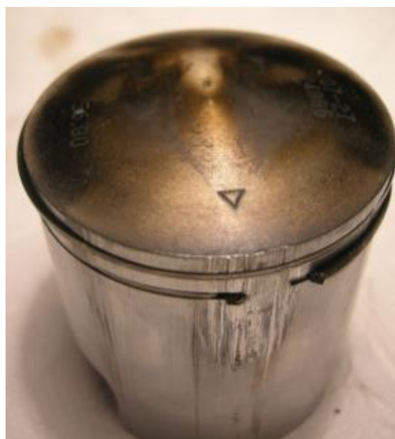
Figura 174: Pistone in lega di alluminio per applicazioni motociclistiche con segni di grippaggio sul lato scarico
