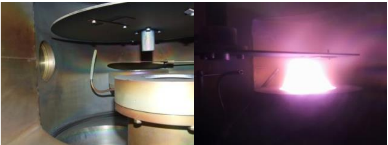
Figura 41: Interno della camera di deposizione MS-PVD
