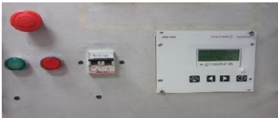
Figura 39: Front panel del sistema di generazione e controllo del vuoto
