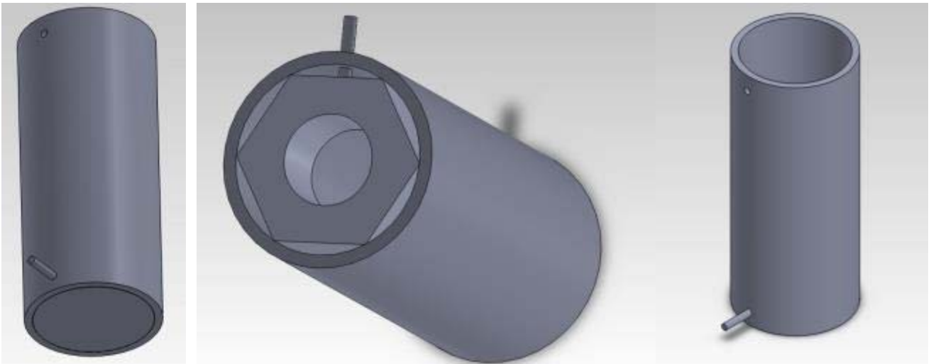
Figura 46: Particolare sistemi di protezione su accoppiamenti nuovo porta campioni
