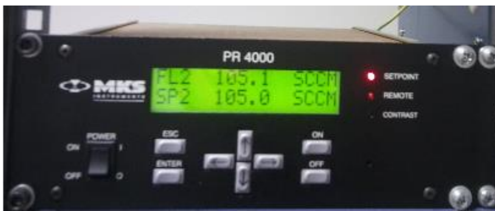
Figura 40: Sistema di controllo dei flussimetri per l'introduzione dei gas in camera
