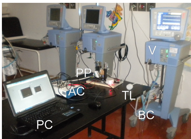
Fig. 5.7. Set-up sperimentale per la misura della pressione differenziale. V: ventilatore neonatale; PP: piattaforma per la misura della pressione differenziale; BC: circuito paziente; TL: infant test lung; AC: scheda di acquisizione; PC: laptop.
