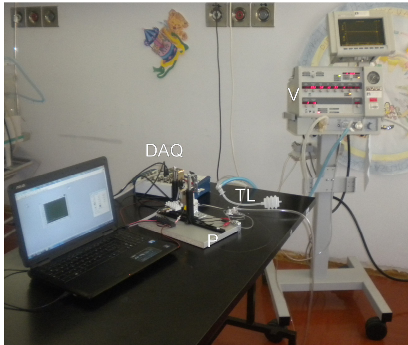
Fig. 4.12. Set-up sperimentale. DAQ: scheda di acquisizione; P: piattaforma con i sensori di pressione differenziale in fibra ottica e di riferimento; TL: polmone test; V: ventilatore polmonare neonatale.
