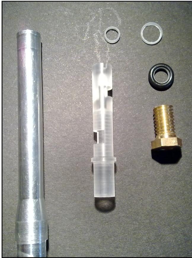
Figura 13 - Componenti meccanici per l'alloggiamento e l'incapsulamento del dosimetro.
