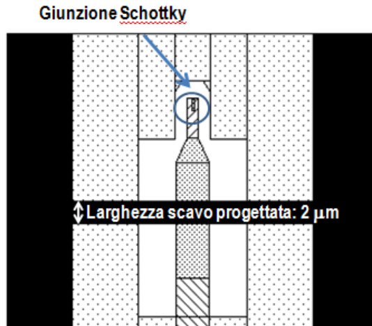
Figura 2.49: Progettazione dell'apertura nel resist mascherante per l'attacco RIE
