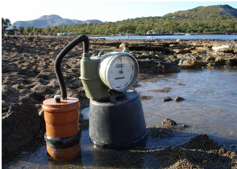
Fig. 7.13. Immagine del sistema di misura di flussi viscosi utilizzato a Vulcano nel maggio 2007.
