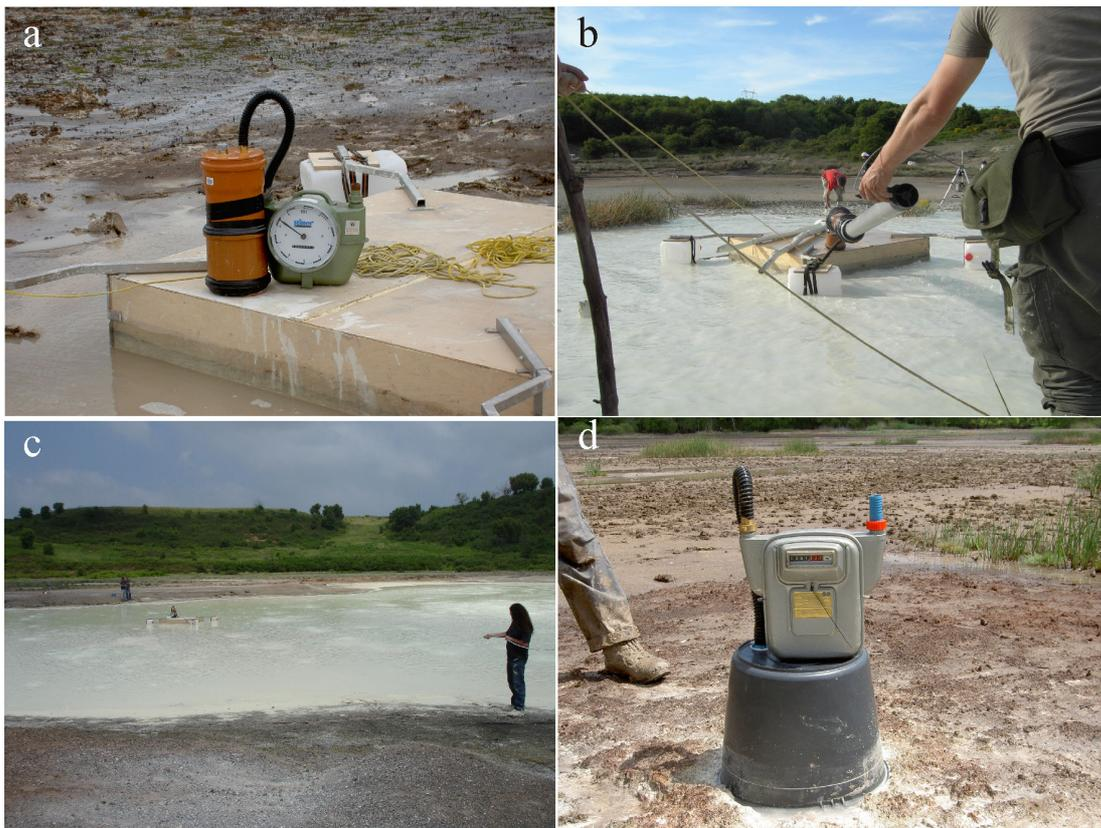
Fig. 2.4. Esempi dei vari sistemi di misura di flusso viscoso utilizzati in questa tesi. a) laPG equipaggiata con contatore di gas; b) laPG con anemometro; c) la PG su grande specchio d'acqua alla Solforata di Pomezia; d) il secchio da 30 cm equipaggiato col contatore di gas.
