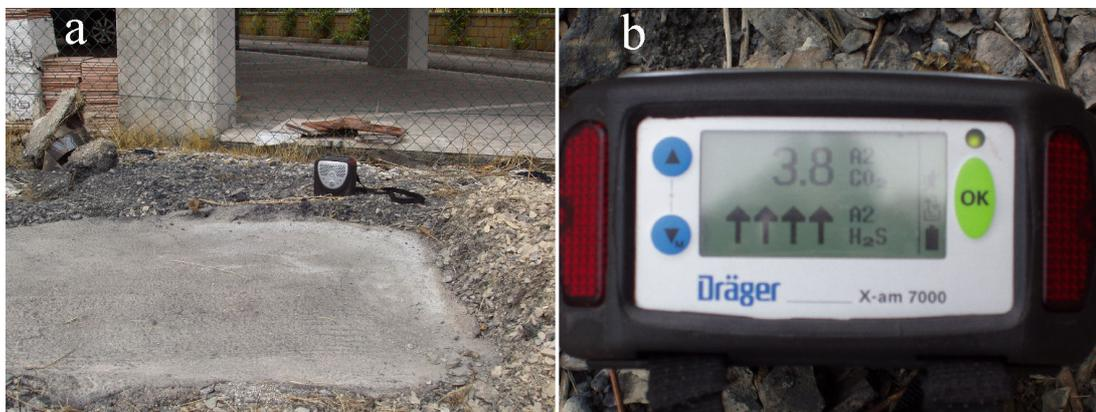
Fig. 2.5. a) Esempio di misura di concentrazione di gas in aria. b) Esempio della pericolosità che si può rilevare: lo strumento sta misurando in aria più di 3 % di CO<sub>2</sub> e più di 500 ppm di H<sub>2</sub>S.
