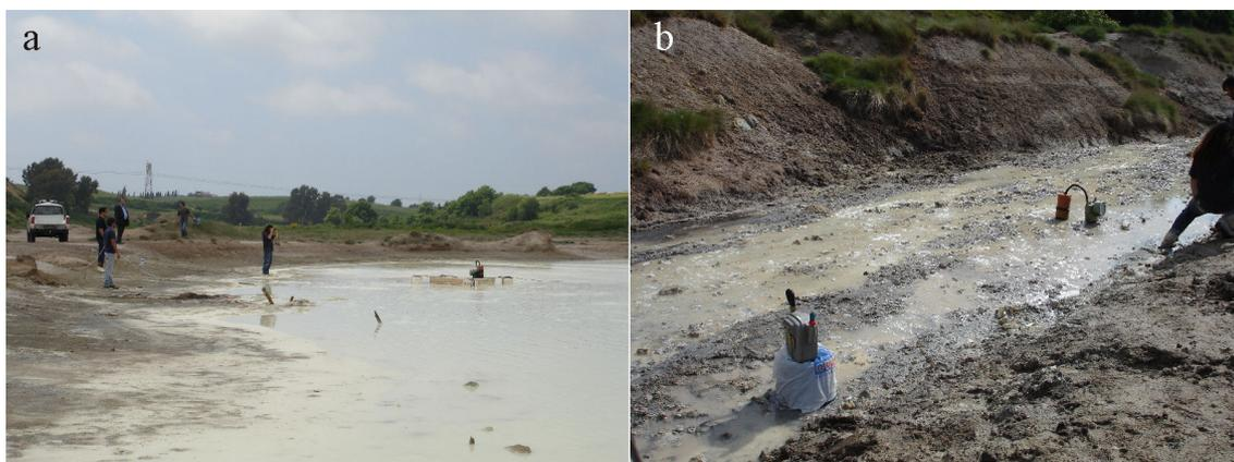
Fig. 4.37. Esempi delle misure di flusso viscoso eseguite alla Solforata di Pomezia nel maggio 2007. a) Piattaforma galleggiante nel laghetto; b) Secchi e contatori nel fosso.
