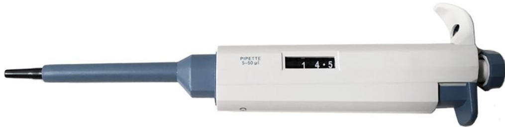
Fig. 2.05: Immagine della siringa microlitrica usata per la deposizione dei CQD sulla scheda. Il range della siringa va da 10µl e 0.5µl.
