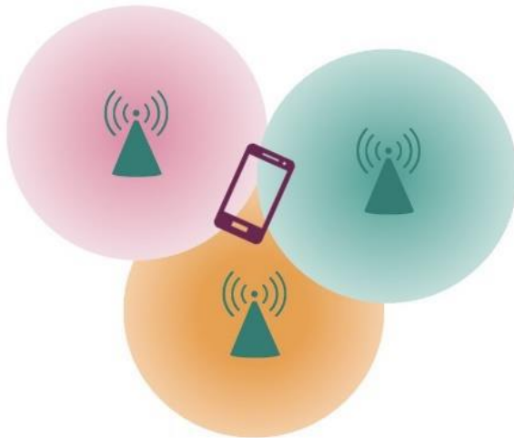
Fig. 8-15 Trilaterazione in una rete Wi-Fi
