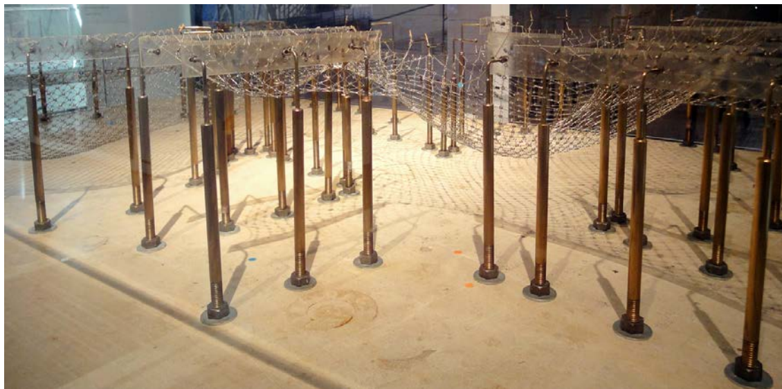
Fig. 2.30 – Il modello utilizzato da Frei Otto durante il processo di form-finding
