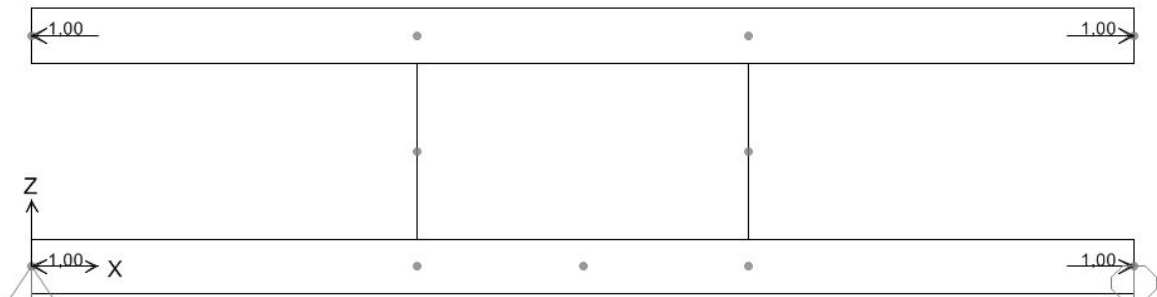
Fig. 4.29 - condizione di carico assiale del modulo di base
