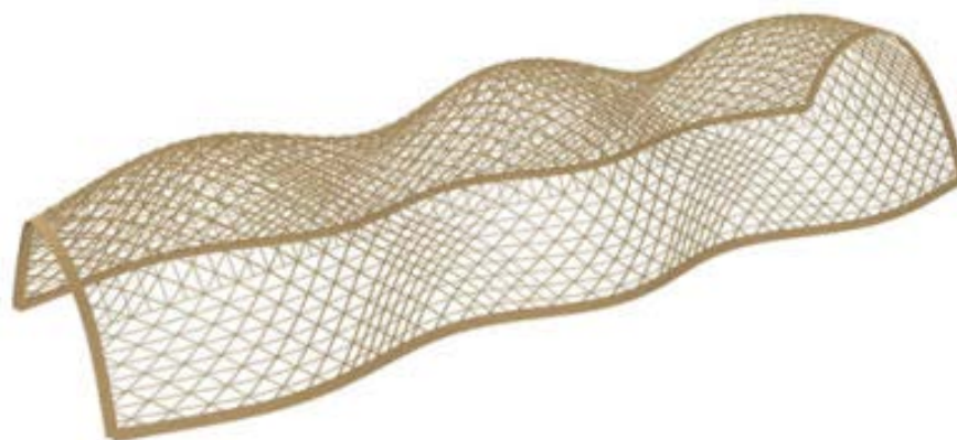
Fig. 2.38 - modello tridimensionale della Downland gridshell
