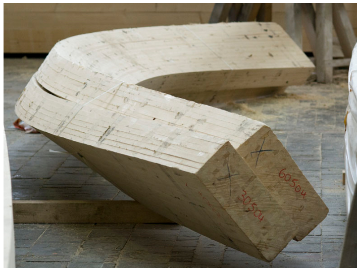
Fig. 2.26 – travi di legno lamellare che compongono la copertura del Centre Pompidou di Metz
