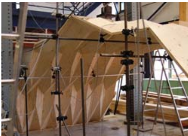
Fig.2.30 Prototipo sul quale sono state realizzate le prove di carico. E' stato realizzato con una geometria semplificata al fine di dimostrare la bontà dei giunti e della resistenza della struttura. Buri, Hani, e Yves Weinand. «Origami aus Brettsperrholz. Origami in legno lamellare.» Detail , 2010: 2-4.
