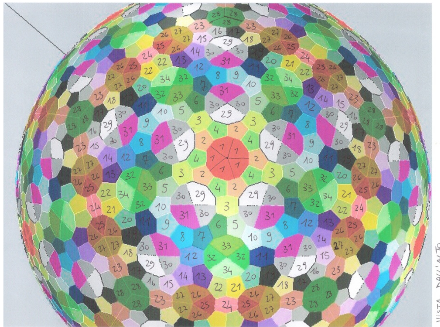
162. R. Gadaleta, Schema a colori per il montaggio della maquette, vista dall'alto, disegno infografico tridimensionale
