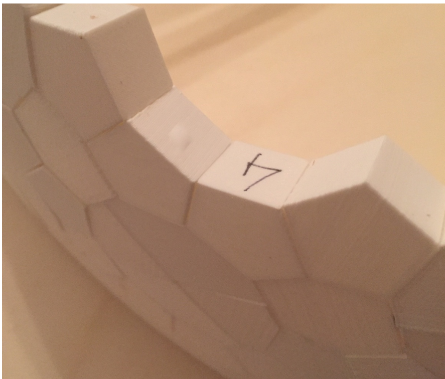
174. Apposizione di una goccia di colla vinilica tra alcuni giunti, fotografia di R. Gadaleta
