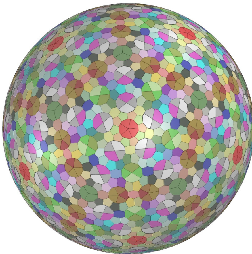
165. R. Gadaleta, Schema geometrico e di montaggio, i conci uguali sono contrassegnati da colori uguali, disegno infografico tridimensionale
