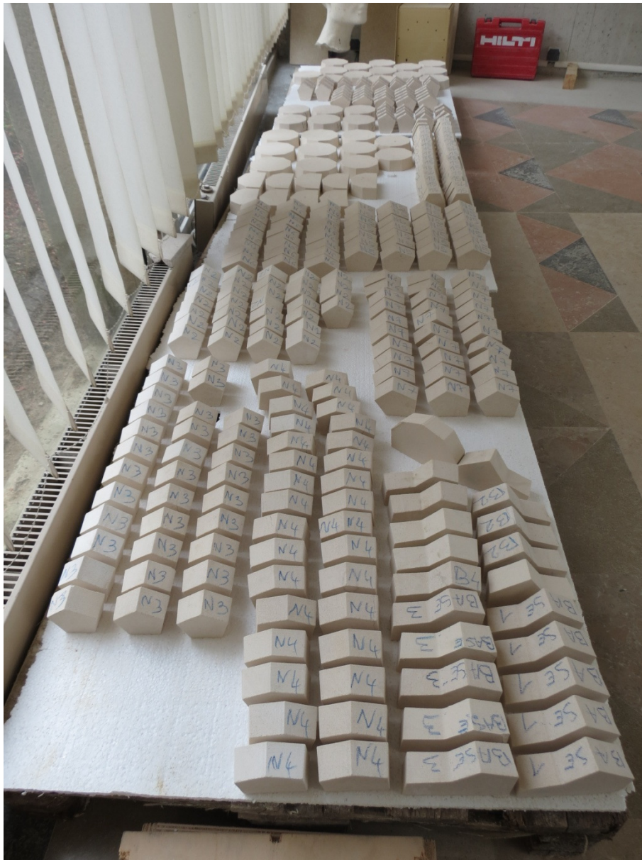
192. Produzione e numerazione dei conci lapidei, SNBR, Sainte-Savine, Francia, fotografia
