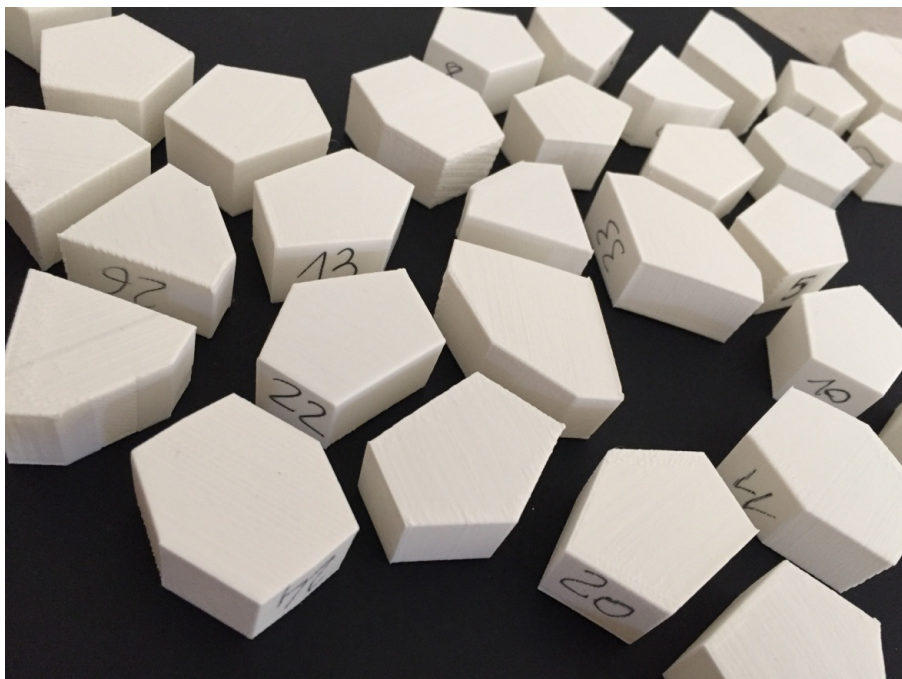
170. Conci numerati con penna e suddivisi in base a numerazione uguale che ne individua uguale tipo, fotografie di R. Gadaleta
