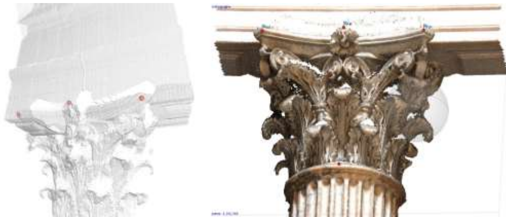
Figura 14 - Orientamento e la scala del modello fotogrammetrico (a destra) grazie ai punti estratti dalla nuvola ottenuta con scansione laser (a sinistra).
