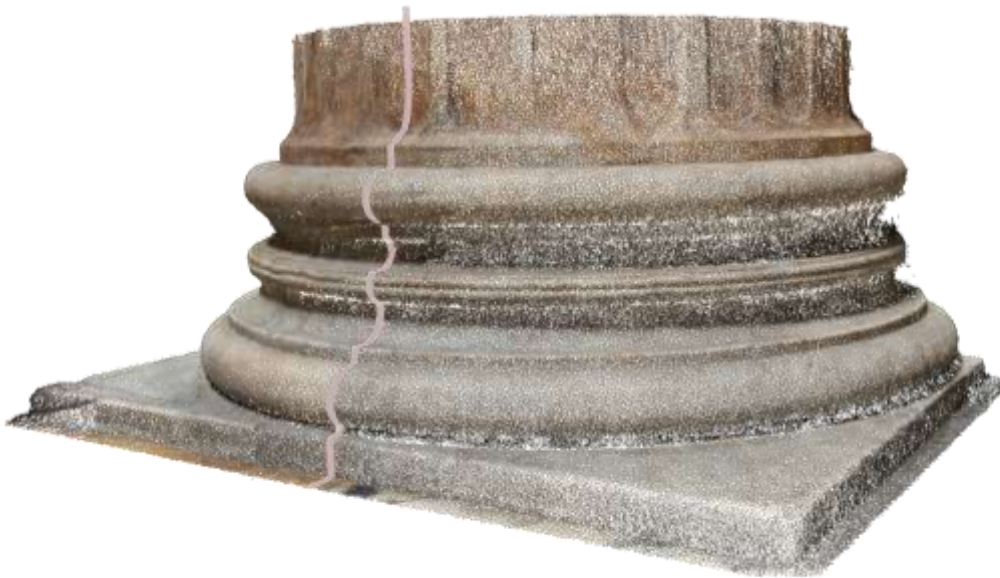
Figura 64 - Base della colonna interna del Pantheon - Nuvola di punti fotogrammetrica con estrazione della sezione verticale.
