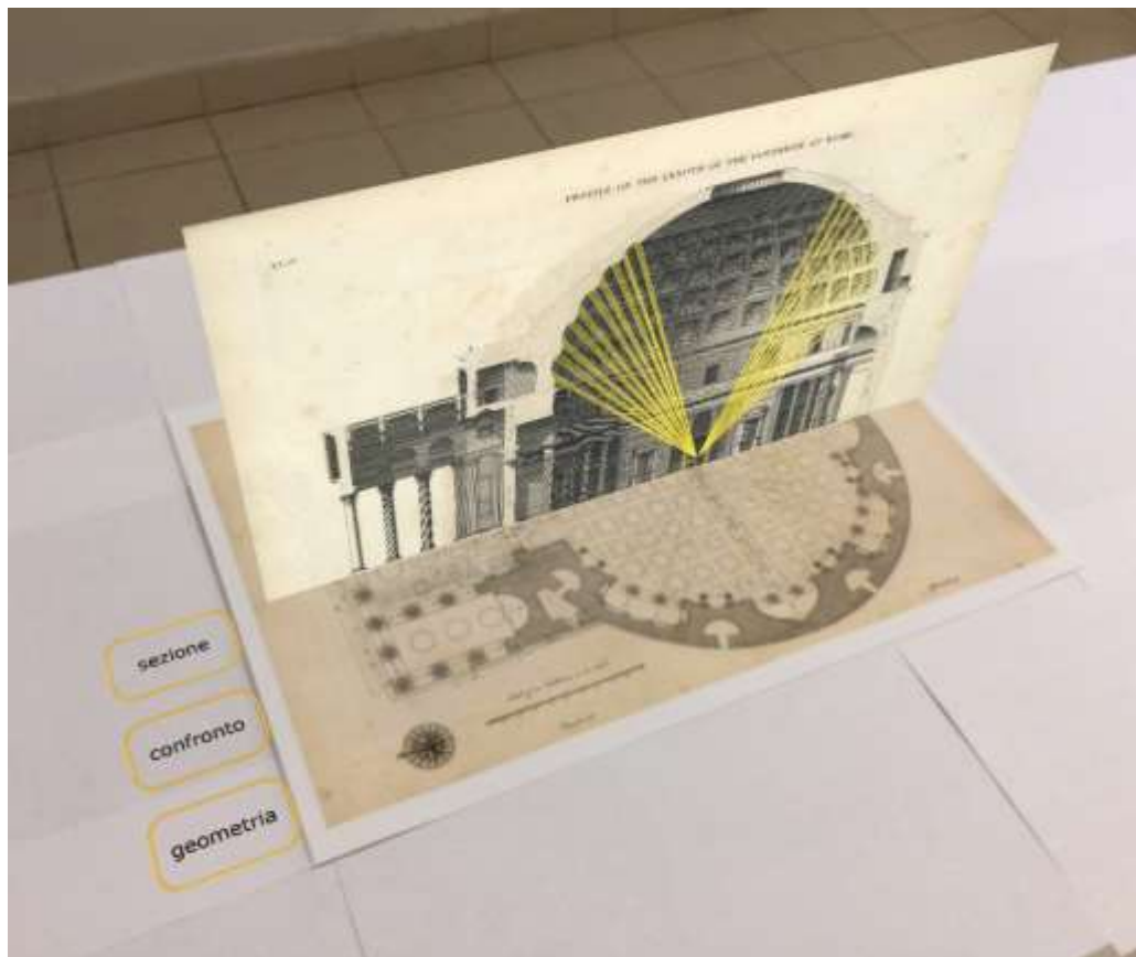
Figura 27 - Scegliendo uno dei contenuti tematici sulla pianta vengono sovrapposti disegni, modelli tridimensionali ed elaborazioni grafiche. In questo caso la sovrapposizione Pianta - Sezione che mostra l'inclinazione dei lati dei cassettoni secondo Desgodets.
