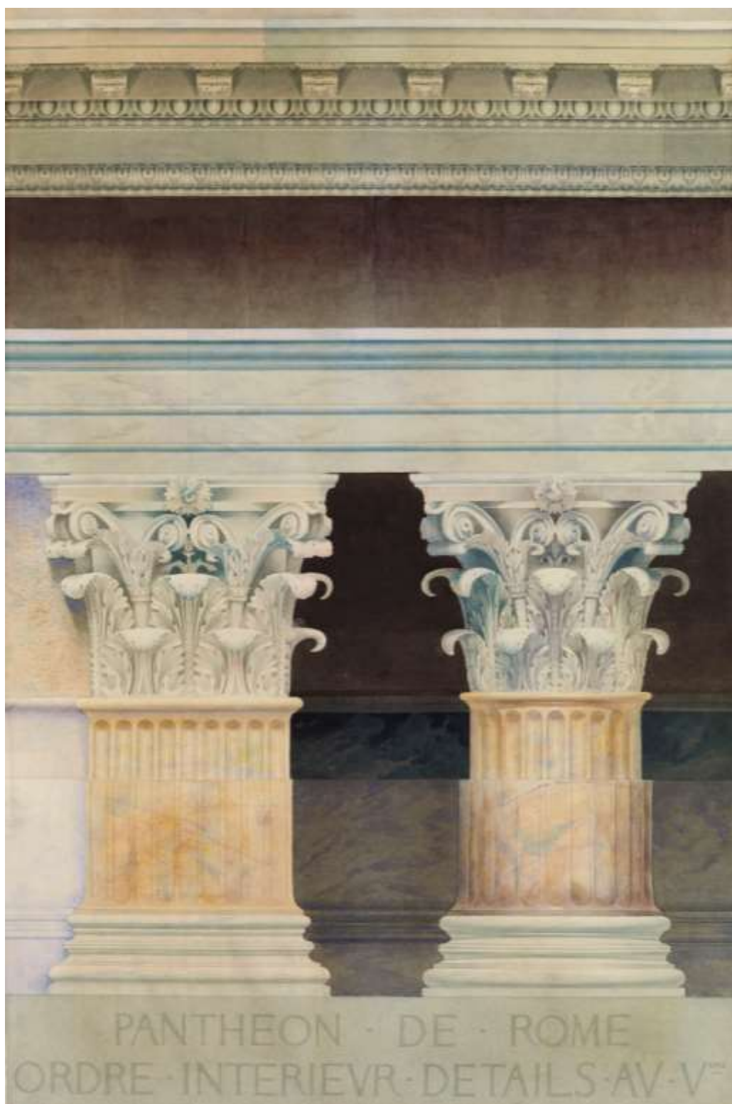
Figura 37 - Dettagli dell'ordine interno - Chedanne 1892
