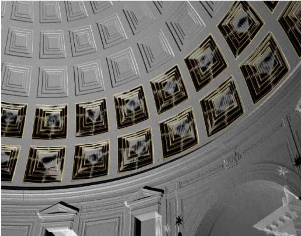
Figura 21 - Sovrapposizione tra la nuvola di punti e il modello geometrico localmente adattato.
