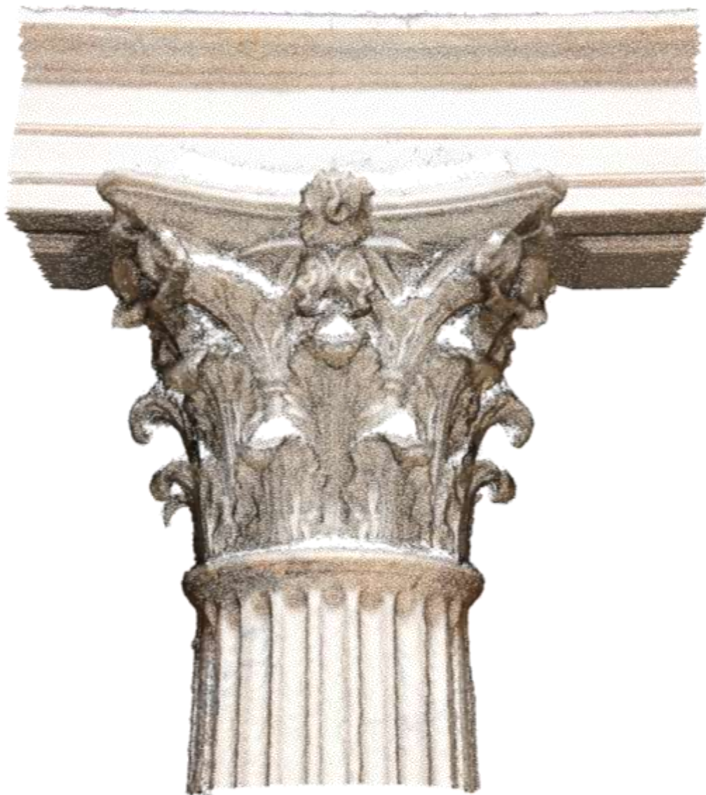
Figura 13 - Il risultato del procedimento di DIM - Una nuvola di punti densa in cui per ogni punto è associato un dato colore proveniente dalle foto.
