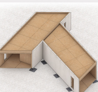
Fase 11 - Posa in opera dei pannelli isolanti di fibra di legno
