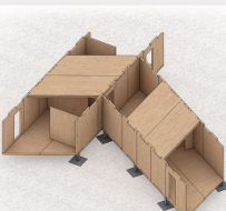
Fase 7a - Posizionamento dei pannelli di copertura in XLAM
