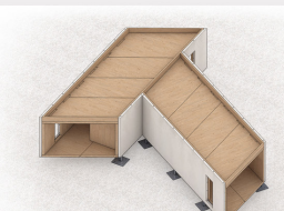
Fase 10 - Posa in opera dell'intonaco di canapa e calce
