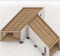
Fase 12 - Posizionamento dei listelli del tetto ventilato
