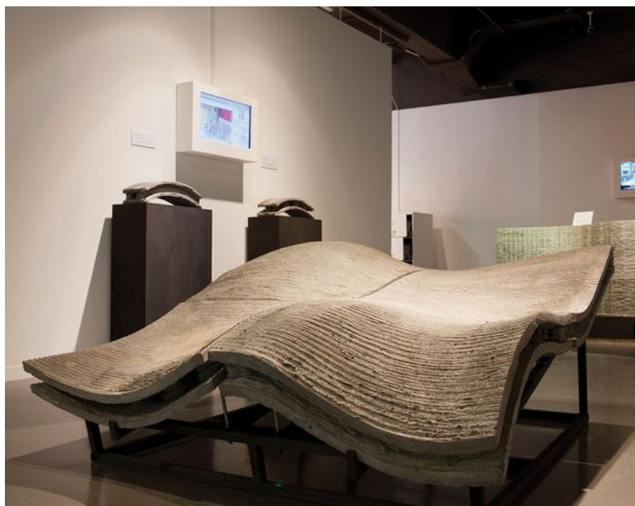
Fig. 9.17 Prototipo di struttura a forma libera ottenuto tramite fabbricazione additiva (fonte: IMCRC).
