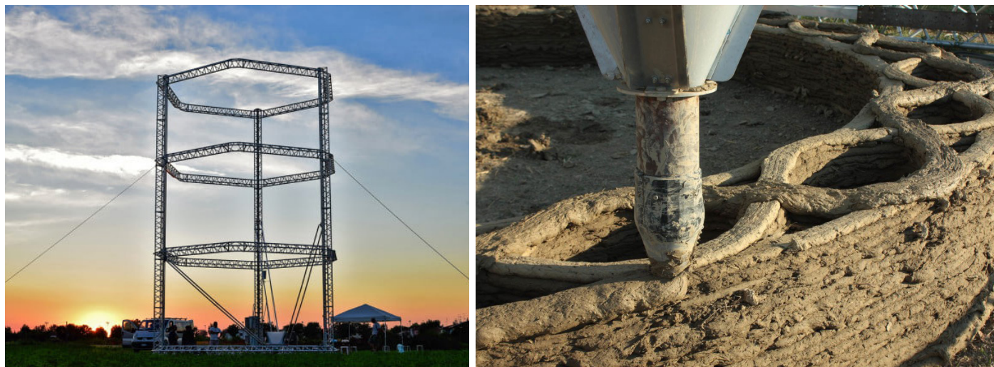
Fig. 9.12 BigDelta della WASP e un dettaglio del processo di estrusione (fonte: WASP).
