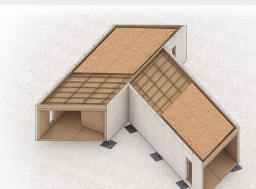
Fase 13 - Posizionamento dei pannelli di legno OSB
