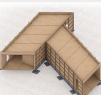
Fase 9 - Posizionamento dei montanti porta-intonaco
