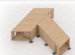
Fase 7b - Posizionamento dei pannelli di copertura in XLAM
