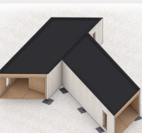
Fase 14 - Posa in opera dello strato di guaina impermeabilizzante
