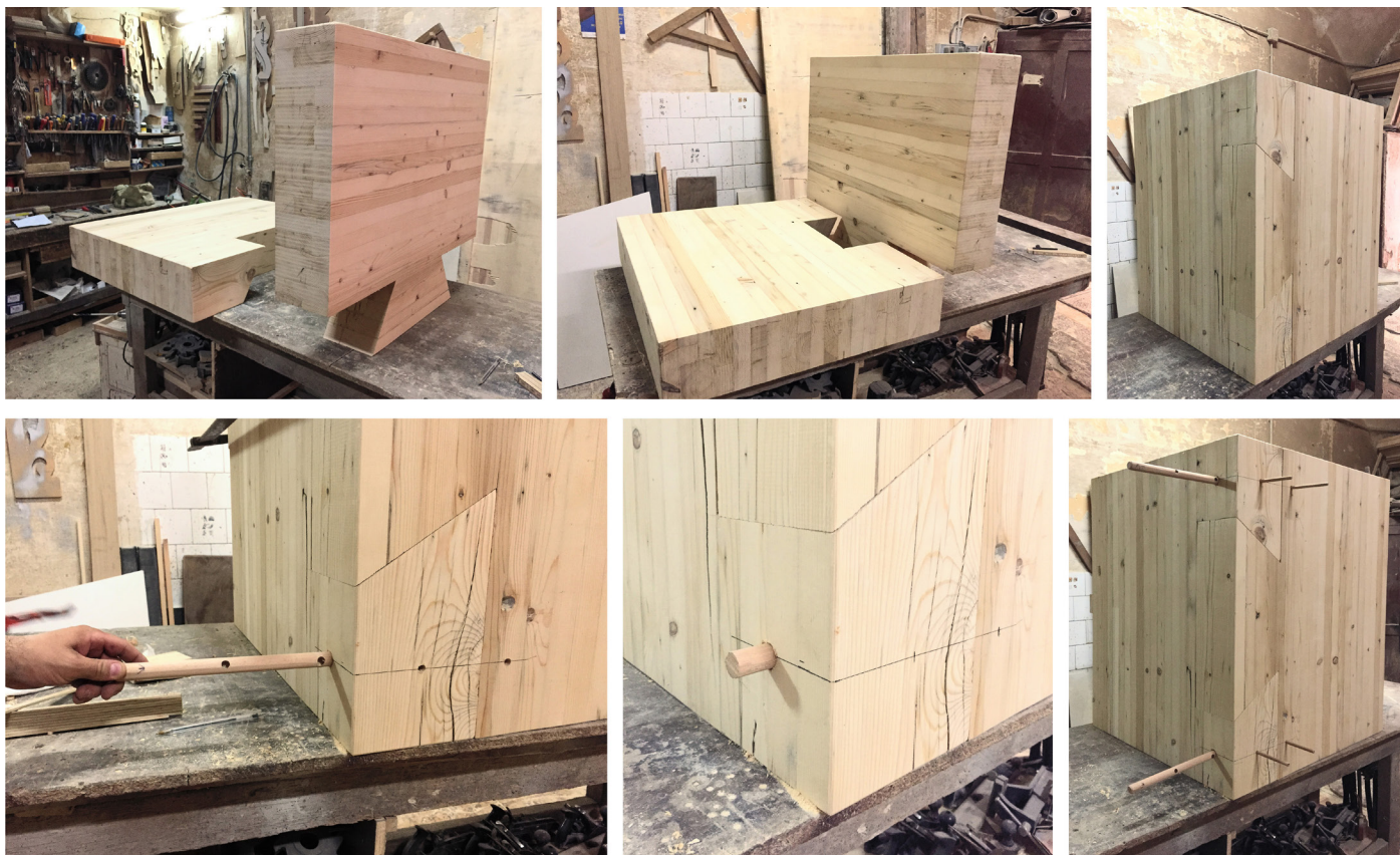
Fig. 7.1.6 Maquette a scala reale della connessione sperimentale legno- legno.
