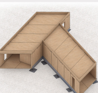
Fase 8 - Posizionamento dei profili porta-intonaco
