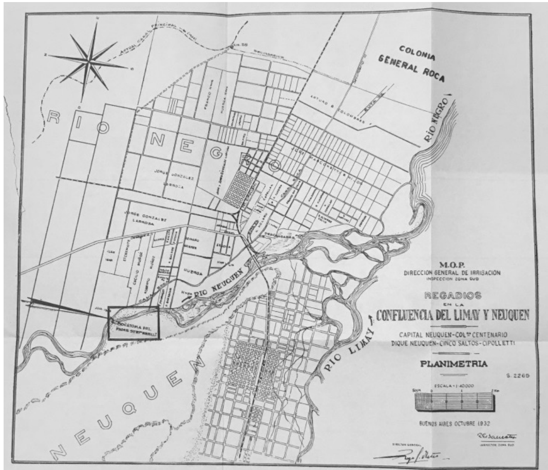
Figura 7.7 Plano de la red de los canales del Alto Valle, y situacion de la bocatoma cavada por el pioner (PAESA, 1964)
