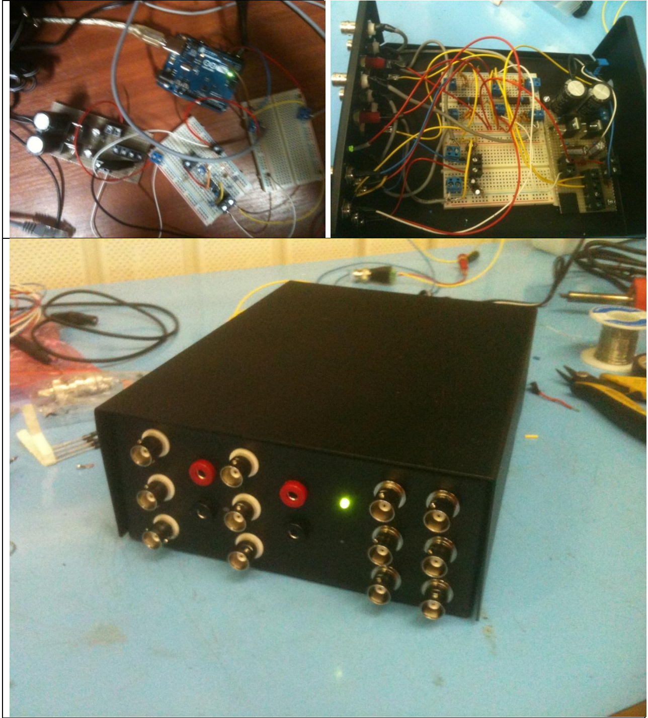
Fig.3.20 Stadio di condizionamento a 6 canali per la coppia di encoder
