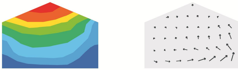
Fig. 4.4: esempio di campo scalare (a sinistra), ad es. delle temperature, rappresentato da “iso-superfici” indicanti il valore numerico ( ^{\circ}\text{C} ); esempio campo vettoriale (a destra), ad es. delle velocità, rappresentato da vettori di cui è necessario conoscere, oltre all'intensità, la direzione e il verso.
