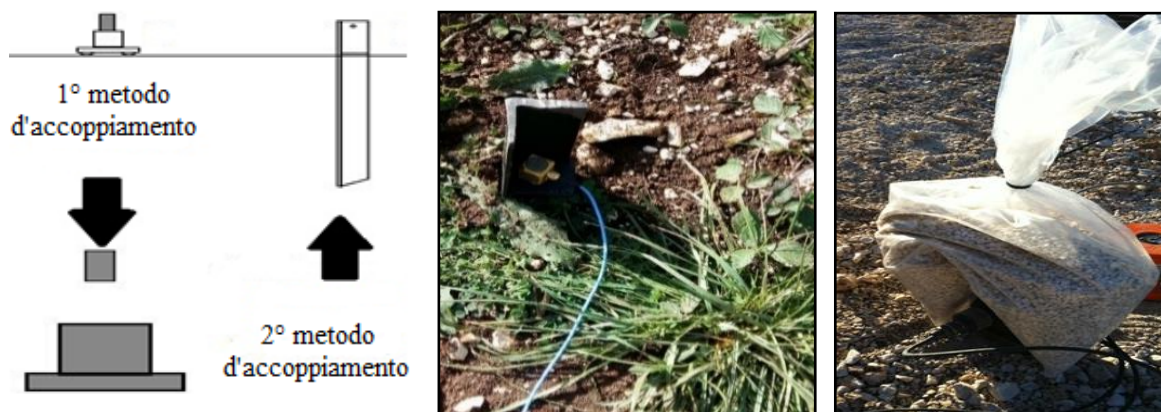
Fig. 279: confronto tra le due metodologie di vincolo (sinistra), vincolo tramite profilato (centro) e tramite sacco (destra)
