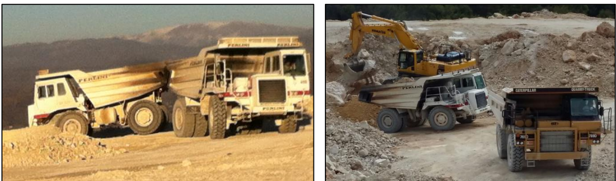
Fig. 70: incrocio dei mezzi durante l'attività di transito(sinistra) e caricamento (destra)
