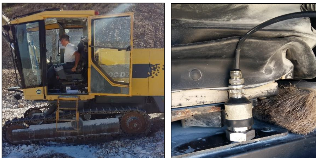
Fig. 27: realizzazione della prova al minimo sulla perforatrice (sinistra) e posizionamento accelerometro sulla pedana (destra)
