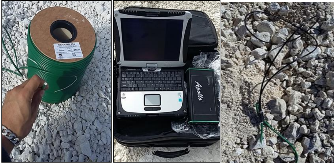
Fig. 259: particolari di preparazione della volata
