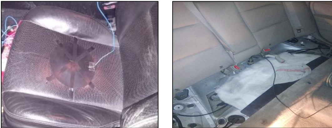
Fig. 76: accelerometro posizionato sul sedile di guida e prova di fissaggio sui sedili posteriori
