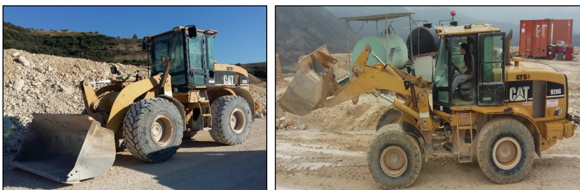
Fig. 19: visuale della pala gommata (sinistra) e attività di spargimento del materiale (destra)
