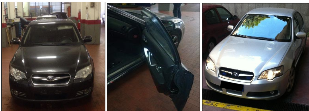
Fig. 82: vettura blindata (sinistra), particolare della blindatura sullo sportello(centro) e vettura standard (destra)
