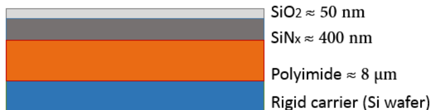
Figura 27. Schema in sezione del substrato plastico in Polyimide e del buffer termico.
