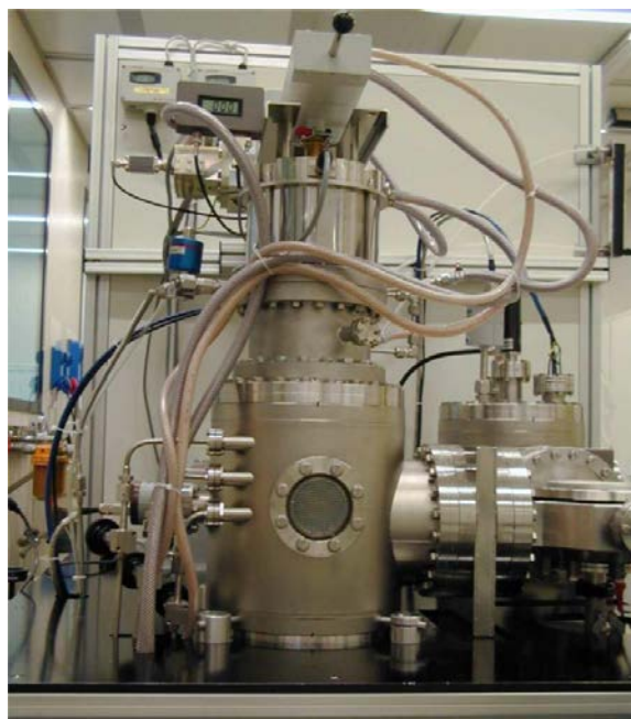
Figura 17. Camera di deposizione ECR utilizzata per la deposizione dell'ossido di gate (CNR-Torvergata, Roma)
