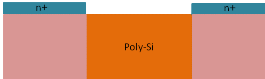
Figura 28. Schema in sezione del substrato dopo il processo di wet etching per la creazione delle regioni di Source e Drain.
