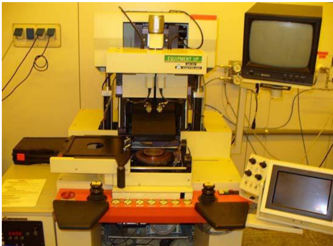
Figura 23. Mask aligner -apparato per la litografia ottica- utilizzato presso il CNR – IMM di Roma Torvergata.
