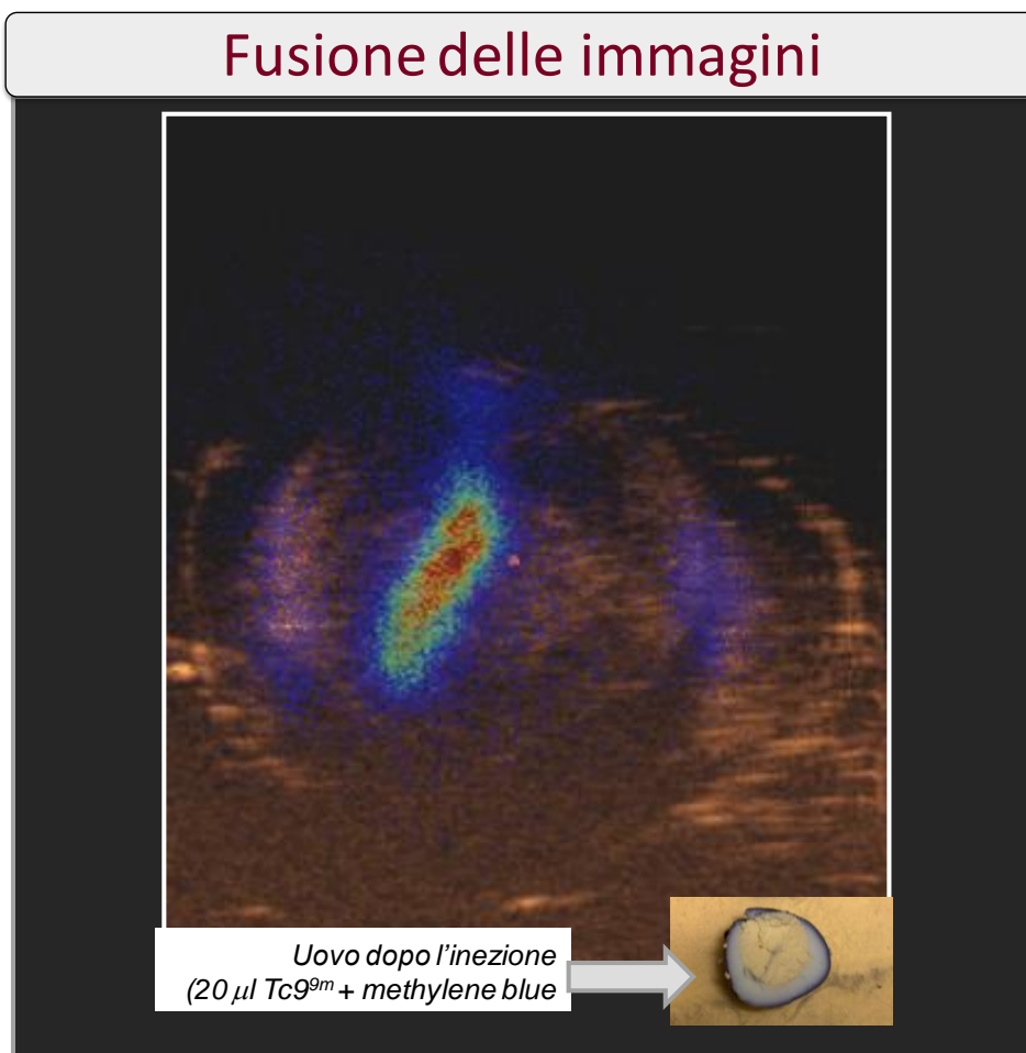
Figura 4.19 Immagine ottenuta dalla fusione della dell'immagine scintigrafica e quella ecografica. In basso la sezione dell'uovo di quaglia dopo la misura conferma la localizzazione del radioattivo all'interno del tuorlo.
