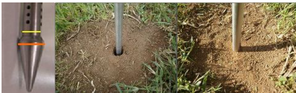
Figura 38. Utilizzo sonda AMS con punta di diametro maggiore del diametro esterno dell'asta cava.
