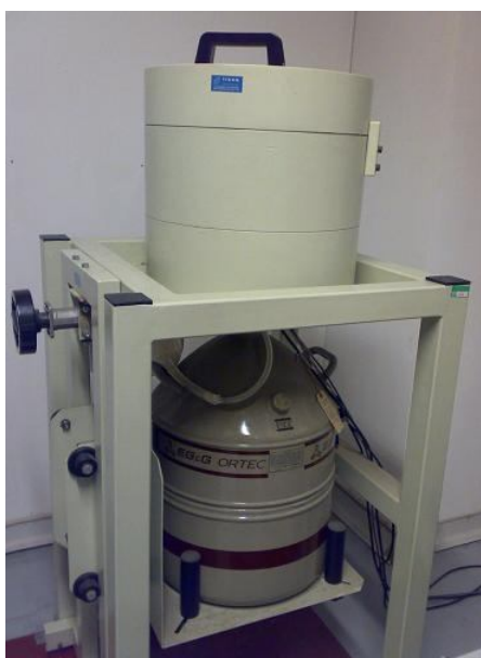
Figura 21. Spettrometro \gamma da laboratorio con rivelatore a semiconduttore (germanio iperpuro).
