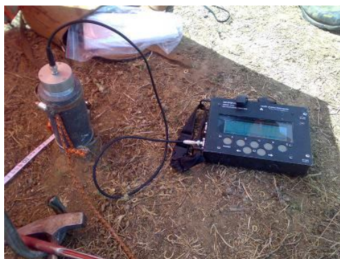
Figura 22. Spettrometro \gamma da campagna con rivelatore a scintillazione (ioduro di sodio drogato con tallio).
