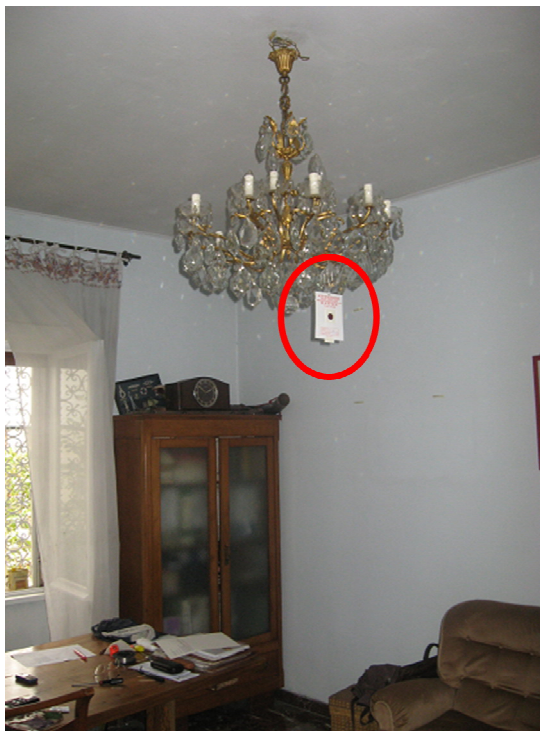
Figura 44. Misura della concentrazione di radon in ambiente indoor con dosimetro RadonAlpha (nel cerchio rosso).
