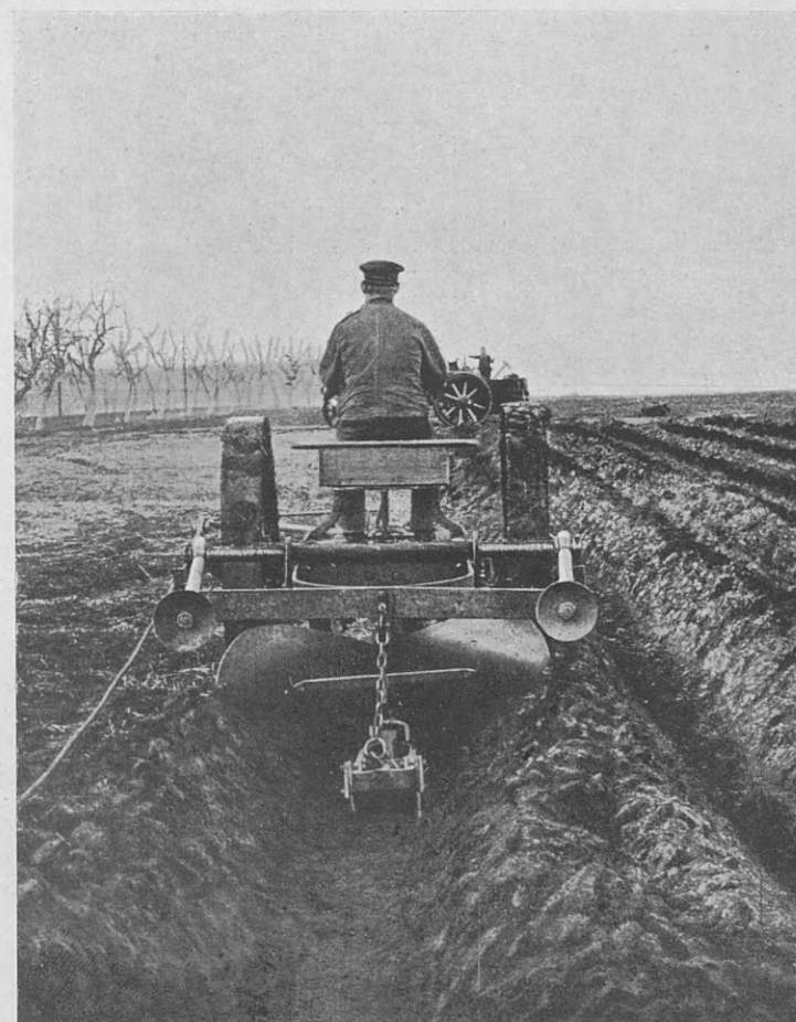
Concessione Romana — Scavatrice di trincee.
