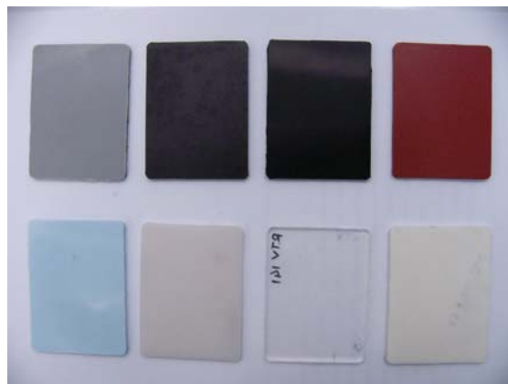
Figura 5.6. Campioni di gomme siliconiche.
