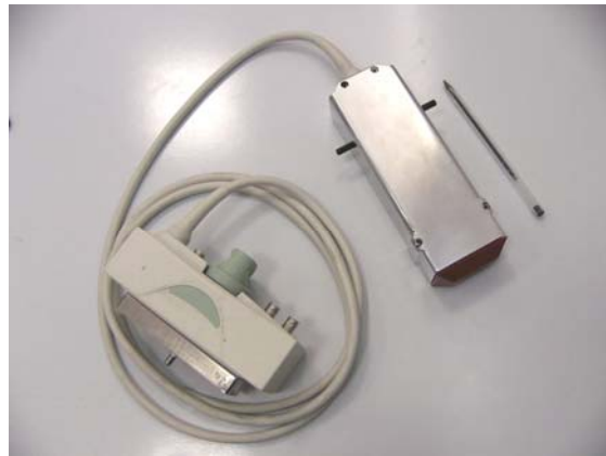
Figura 7.1. Sonda ecografica cMUT con cavo e connettore ZIF.
