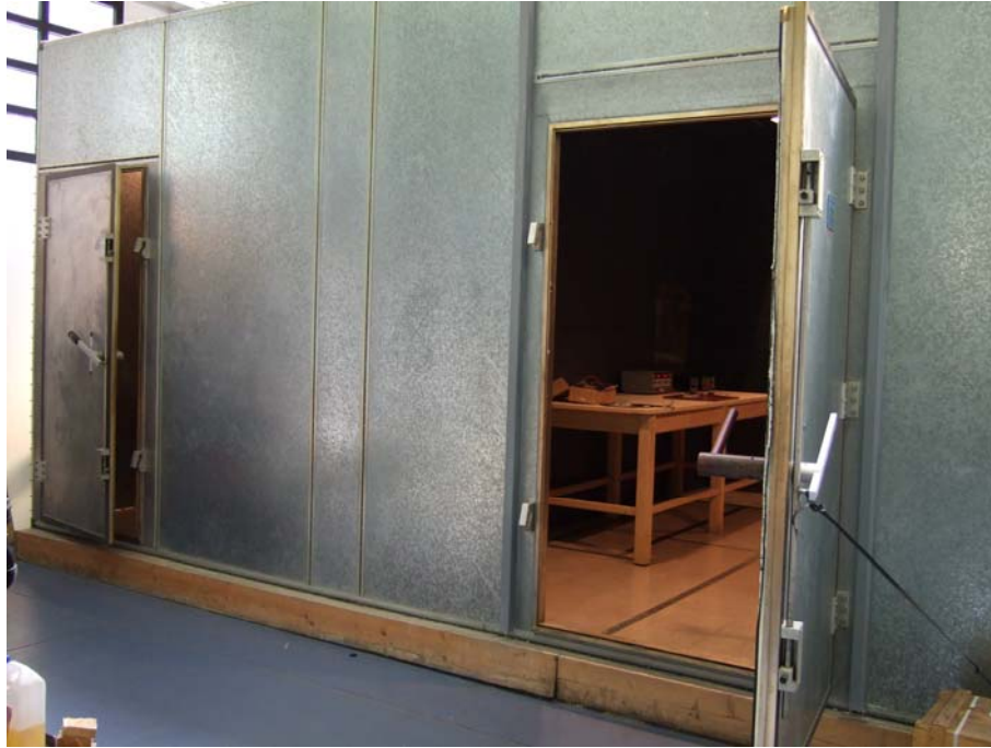
Fig. 4.2: Esterno della camera semianecoica
