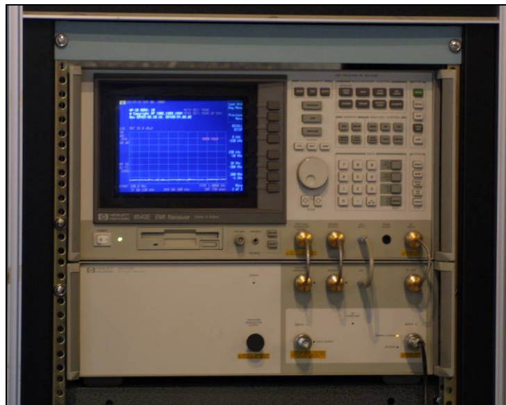
Fig. 4.6: Ricevitore EMI utilizzato per le prove di emissione
