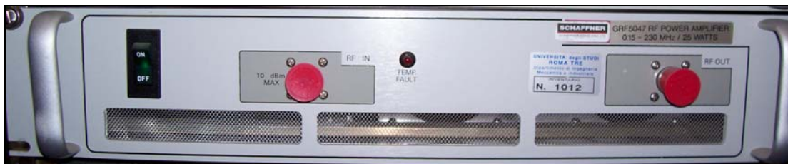
Fig. 4.8: Amplificatore di potenza a banda larga utilizzato per le prove di immunità condotta
