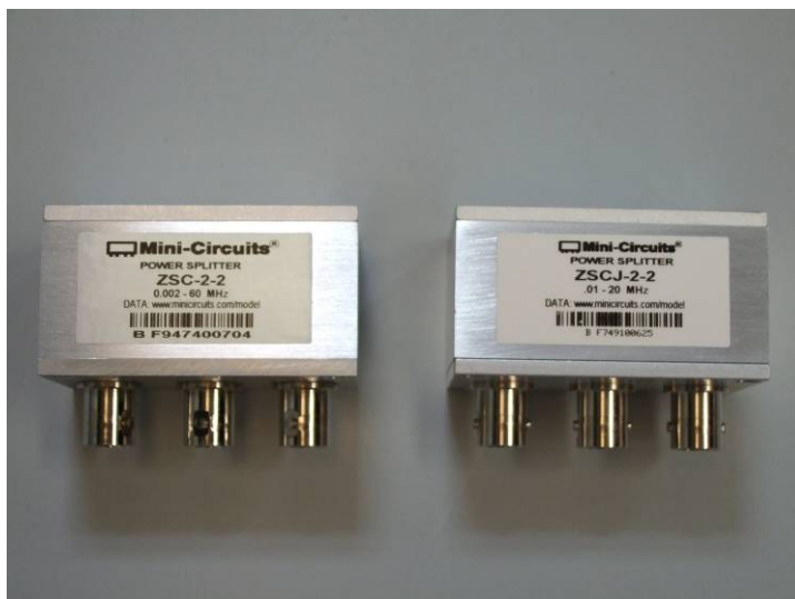
Fig. 5.51: Power splitter/combiner utilizzati
