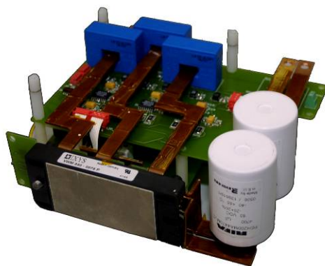
Fig. 5.10: Inverter di trazione della singola motoruota della wheelchair
