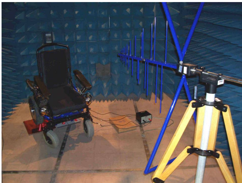
Fig. 5.13: Set-up di prova per la misura delle emissioni irradiate dalla wheelchair
